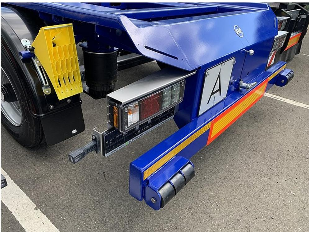
Unterfahrschutz mit Anfahrrollen und Bedienung für die zentrale Fallstütze
