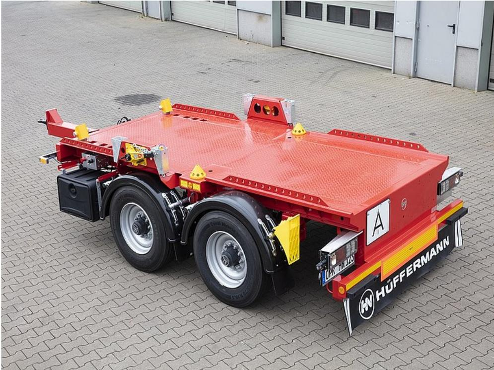
Sonderausstattung geschlossener Ladeboden aus Stahlblech und Safety-Fix
