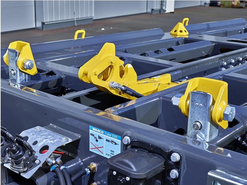
OPTIONAL: Kettenlose Ladungssicherung - verstellbarer Multi-Fix
