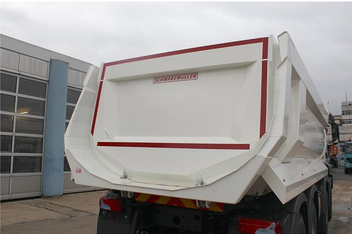
Stahlblech-Rückwand = Pendelwand mit versenkter Lagerung
