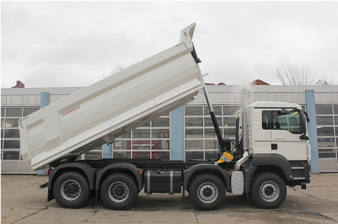
Stahl-Segmentmulden-Kippaufbau auf 4-Achs-LKW
