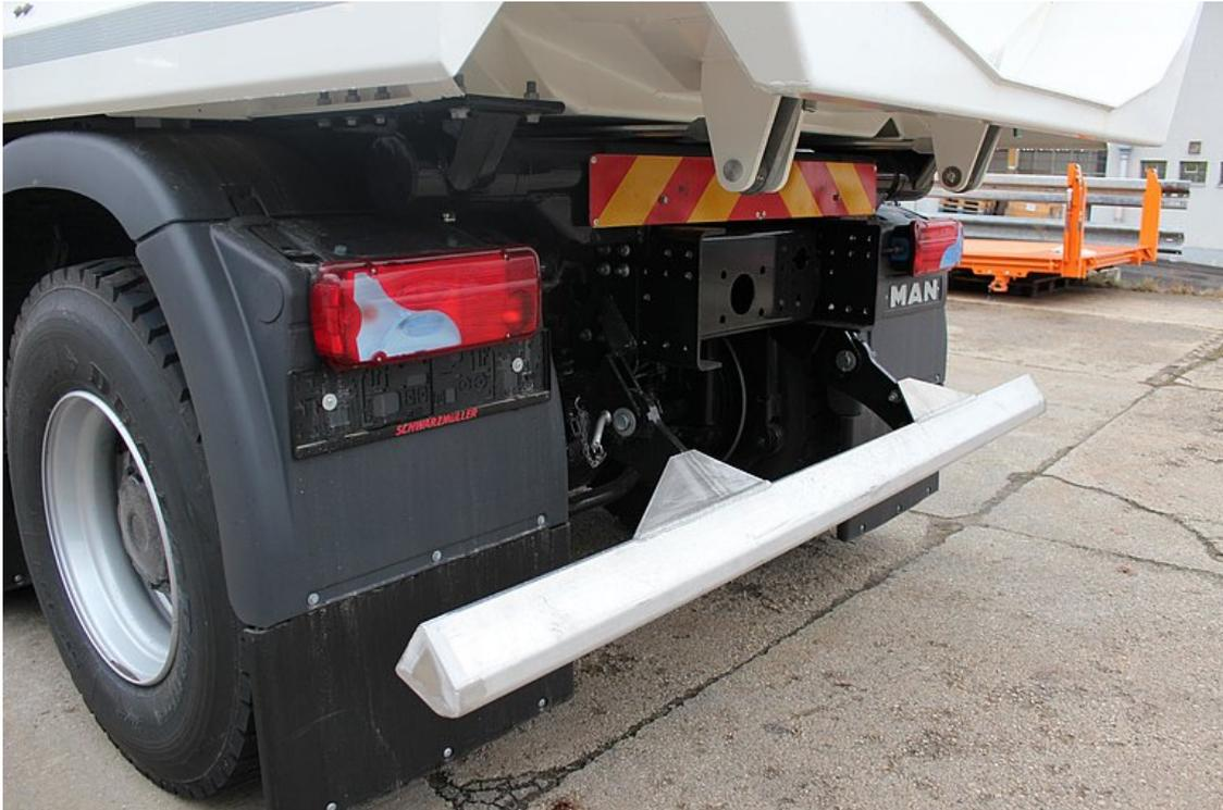
OPTIONAL: Hochklappbarer Aluminium-Unterfahrerschutz
