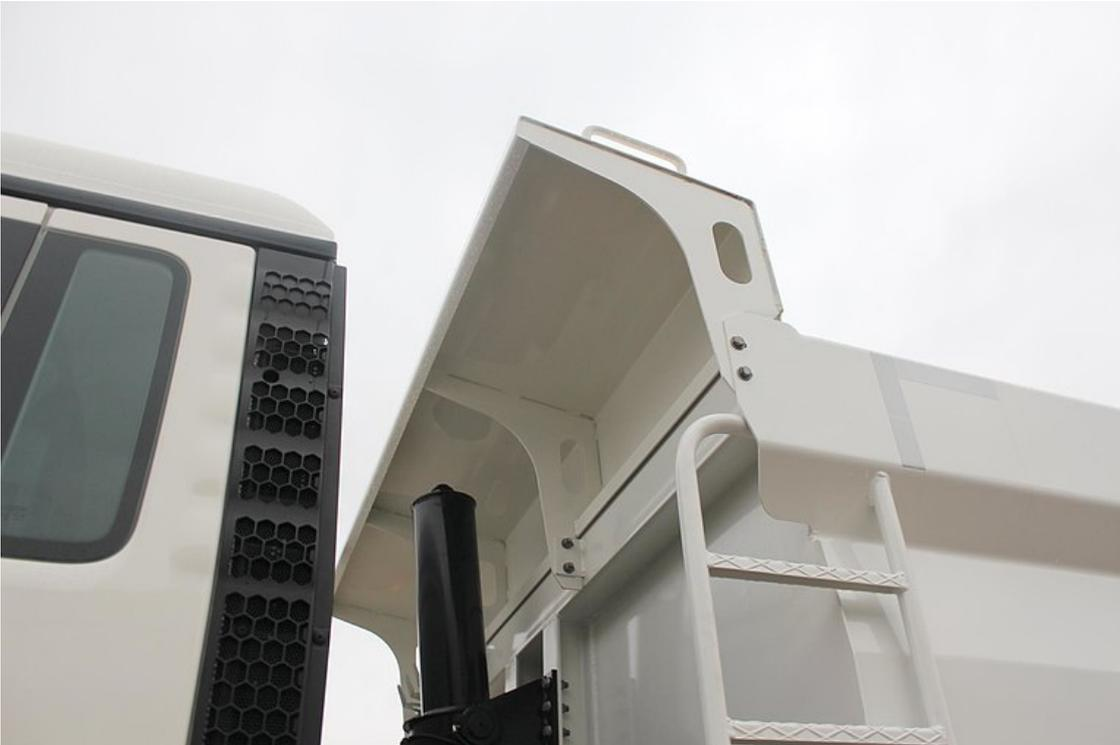
Vorderwand oben mit erhöhtem Baggerschutz
