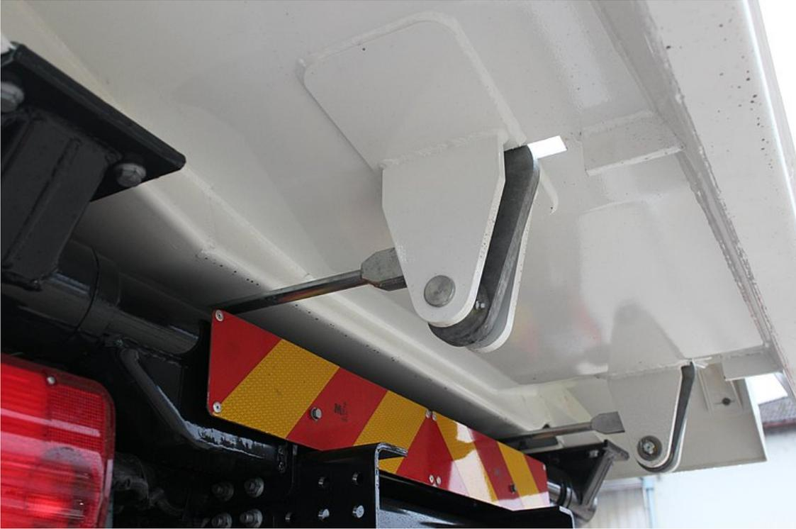
Automatische, mechanische Rückwandverriegelung
