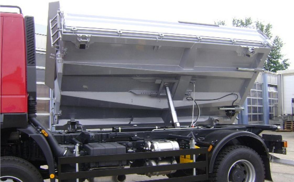
Kipperbrückenkonstruktion mittels konischer Trapezprofil-Längsträger in hochfester Leichtbauweise mit kleinen Bodenfeldern für große Beulfestigkeit und hoher Stoßabfederung
