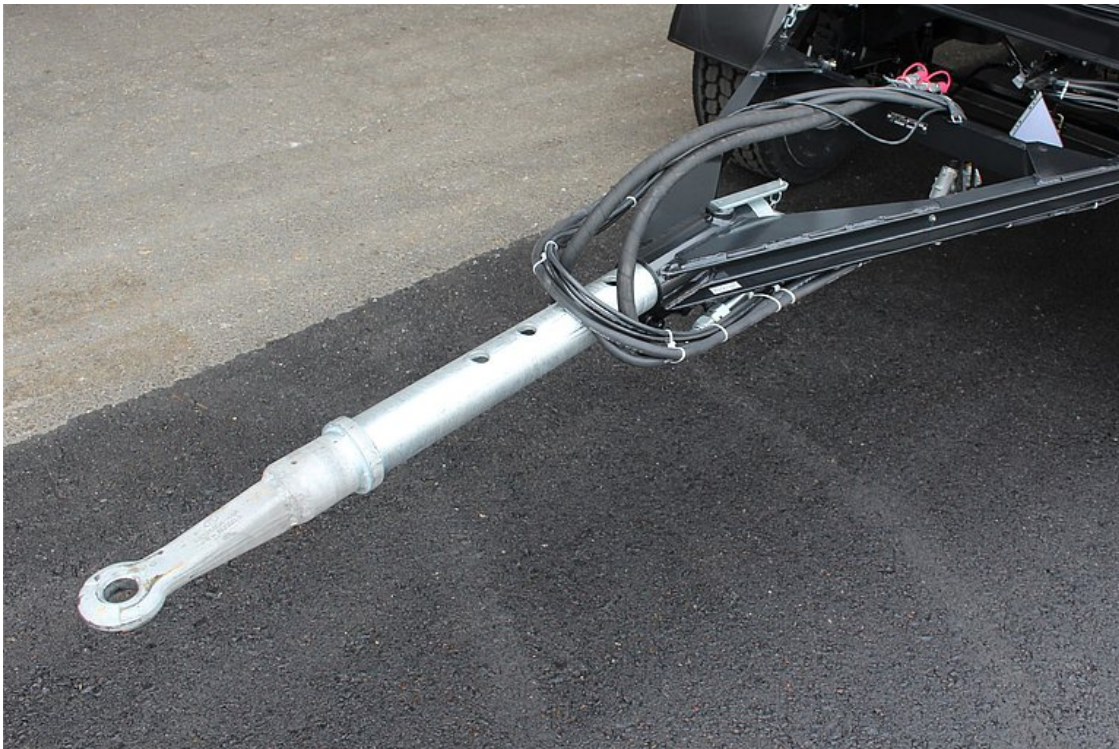
VOLITELNĚ: výsuvná oj, max. 600 mm přestavitelná, s GETOFIX opěrou
