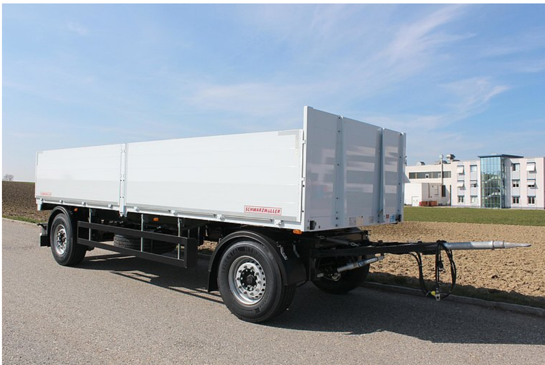
2-nápravový valníkový přívěs - stavební provedení
