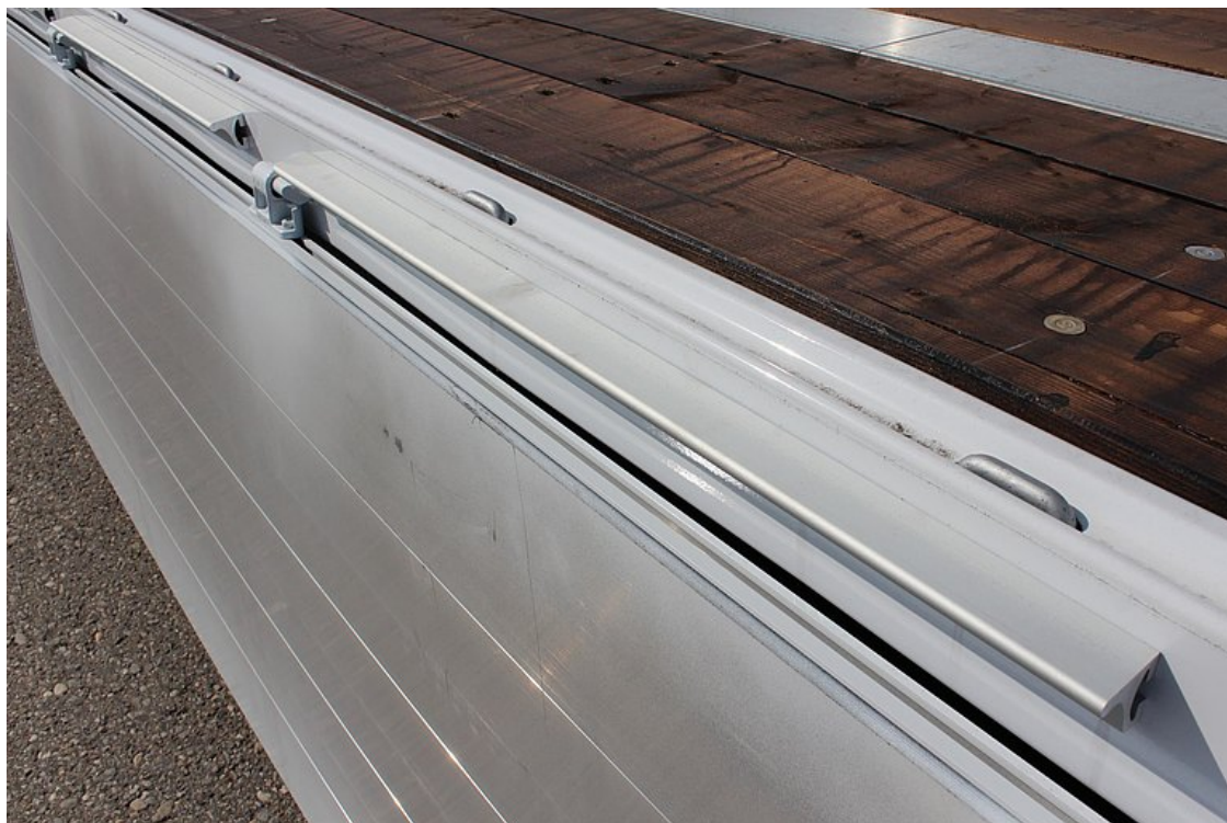
15 párů zapuštěných kotevních třmenů ve vnějším rámu pro zajištění nákladu
