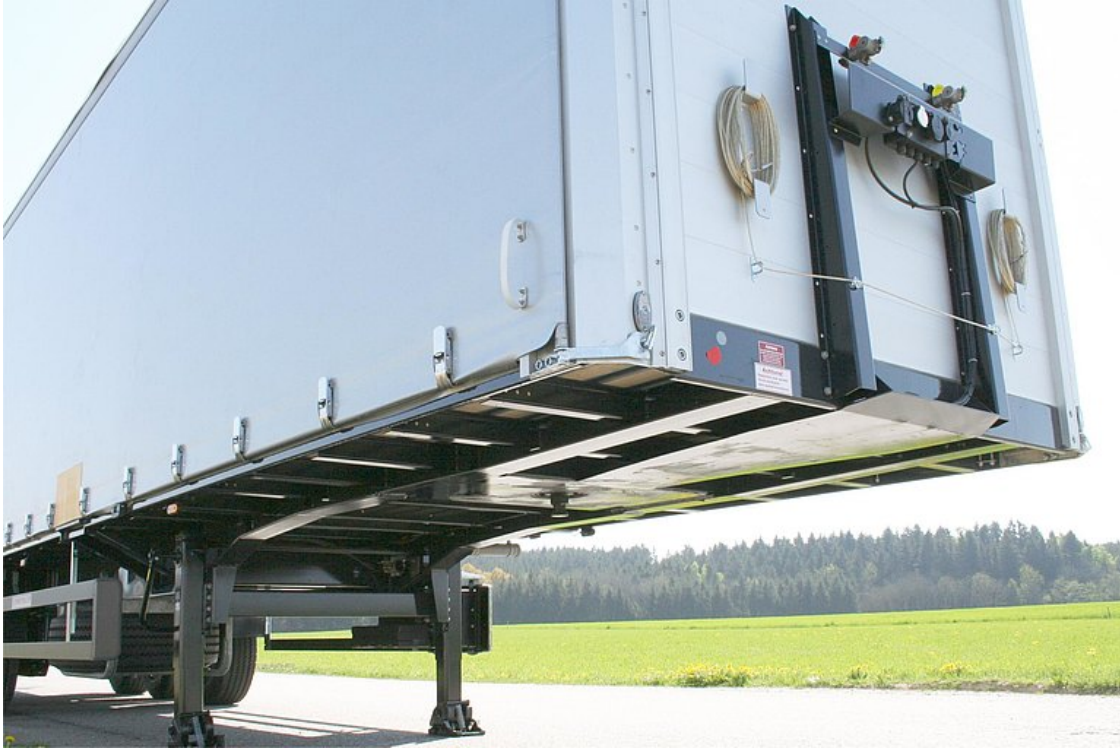
Tuhý žebřinový rám ocelové svařované konstrukce
