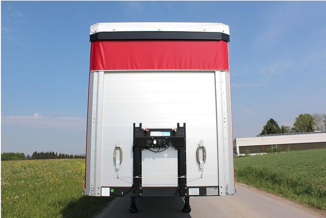
Zesílená přední stěna z hliníkových dutých profilů s integrovaným držákem napájecích přípojů
