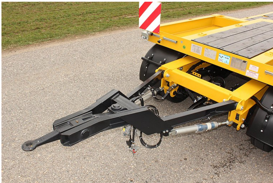
VOLITELNĚ: zalomená tažná oj s vysokožátěžovým okem 40 + 50 mm
