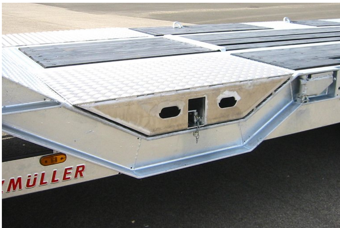
Vybrání pro kola v různých provedeních pro přepravu speciálních stavebních strojů
