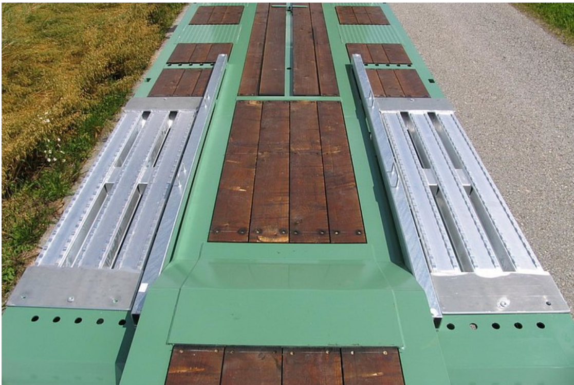
Vybrání pro kola s přejezdovým hliníkovým zakrytím
