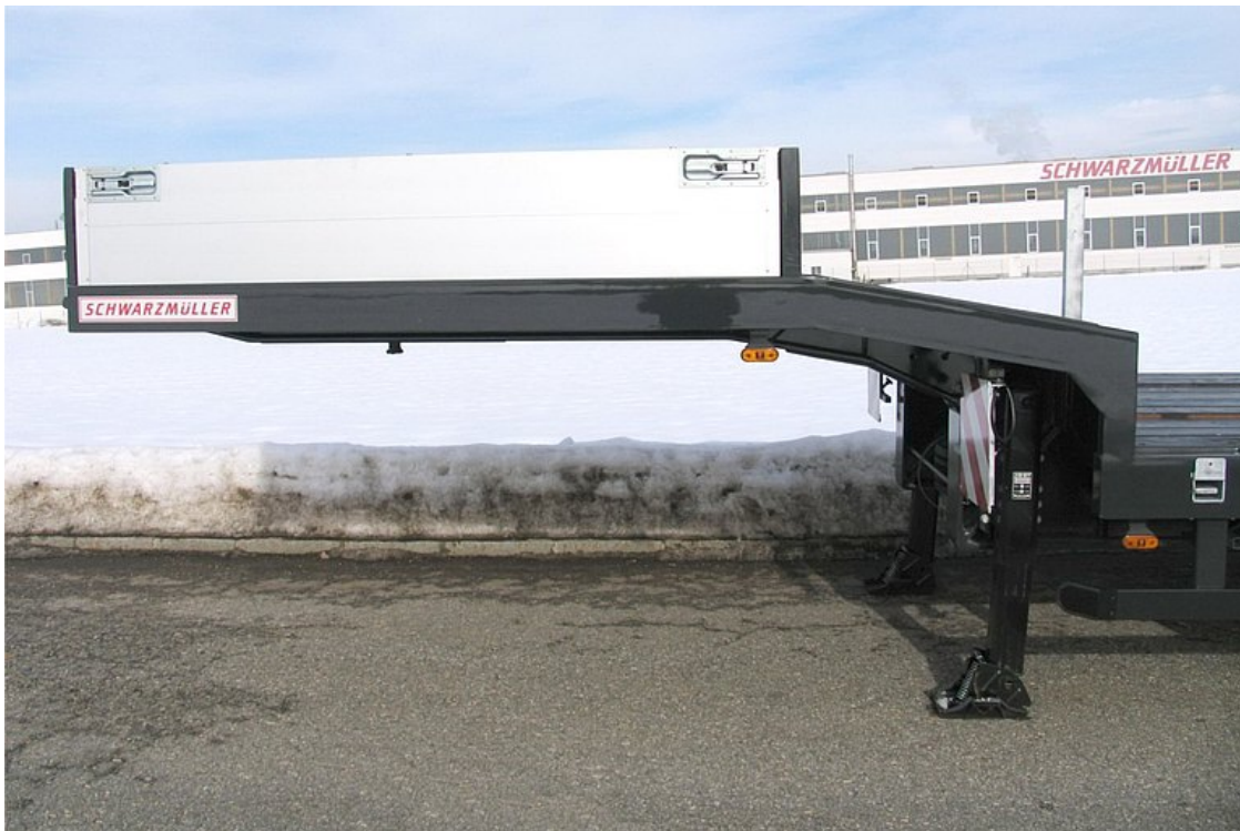
Vpředu zvýšená zalomená plošina vč. nasazovacích bočnic
