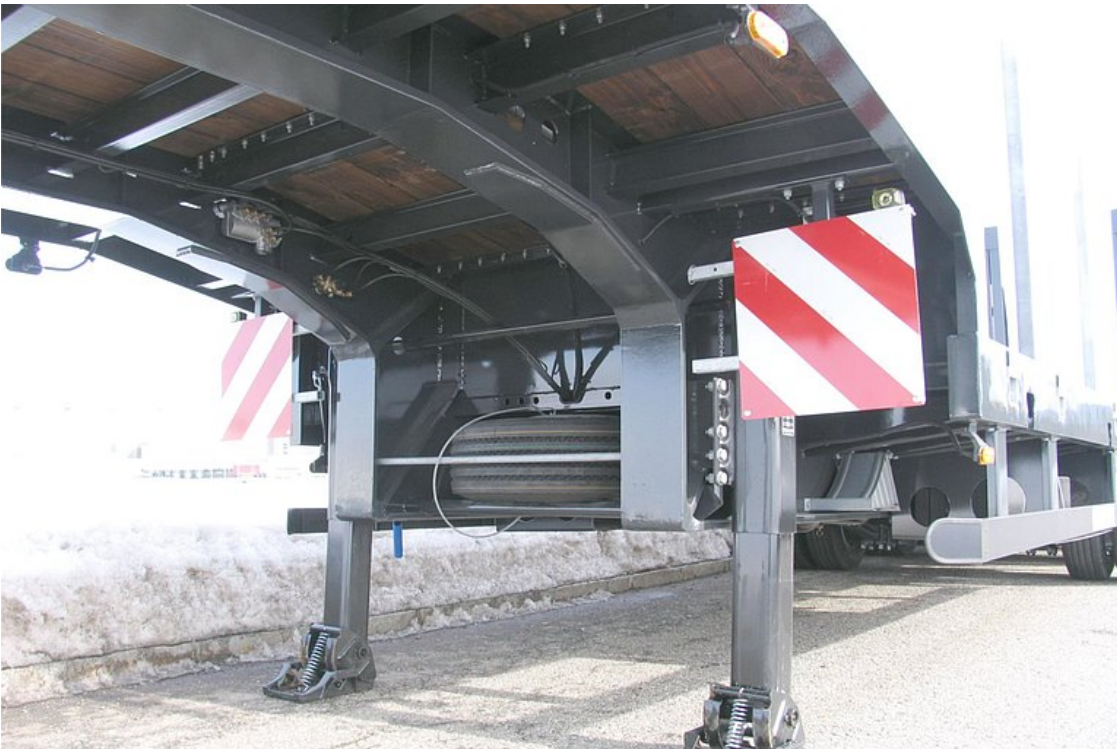
Zesílená a tuhá svařovaná ocelová konstrukce s těsným rozestupem příčnicků pro vysoké bodové zatížení
