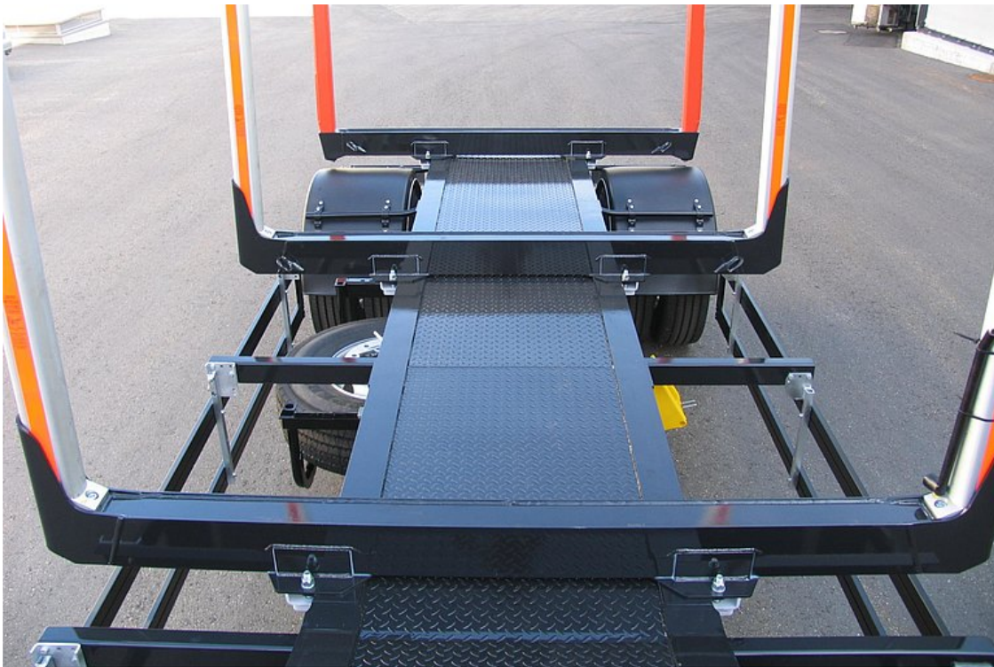
Zakrytí mezi podélníky rámu z ocelového žebrovaného plechu
