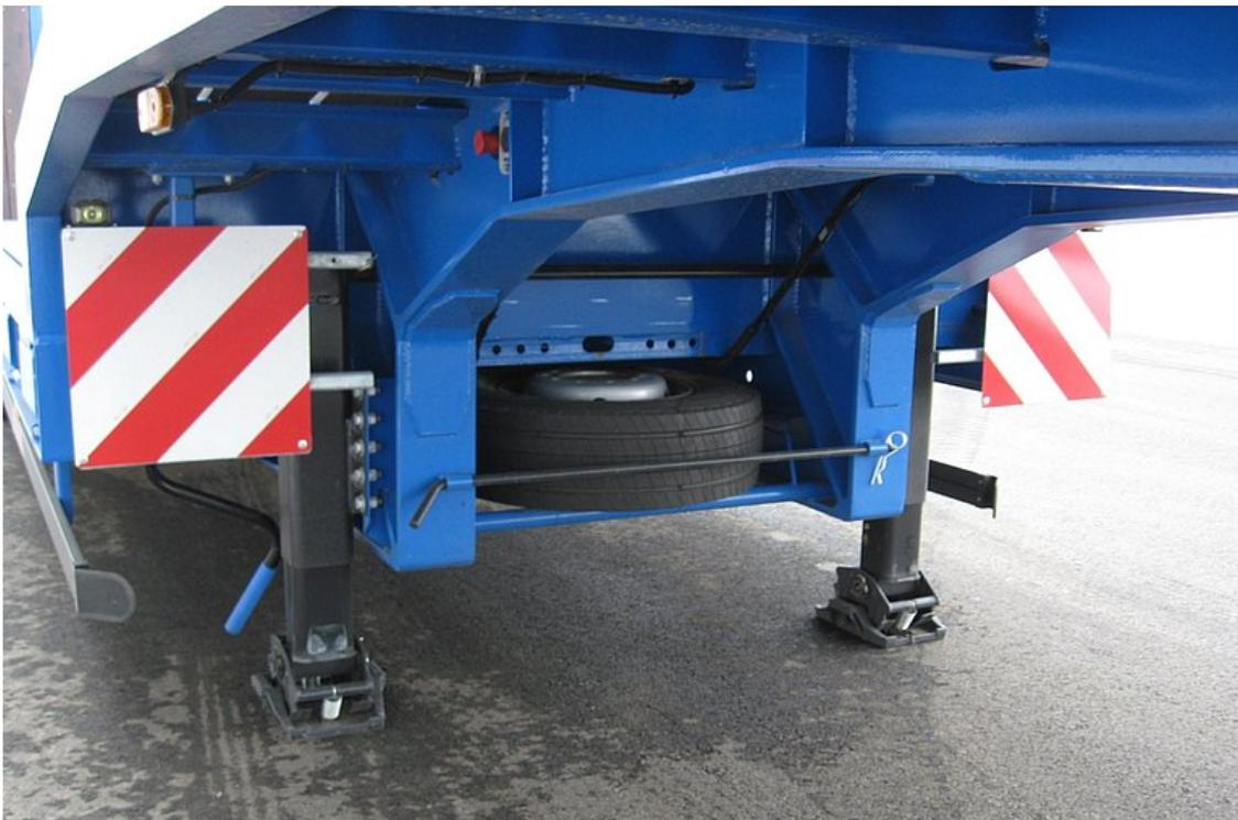
Stahlschweißkonstruktion - Hohe Punktbelastung durch engen Querträgerabstand
