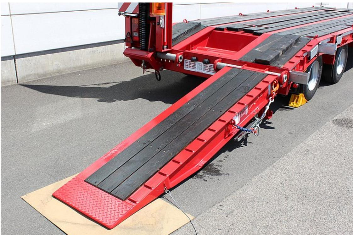
Auffahrrampen mit Hartholzbelag und aufgeschweißten Vierkantrippen
