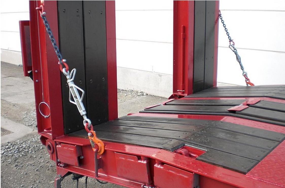
Zusätzliche Kettensicherung der Auffahrampen für sichere Transporte
