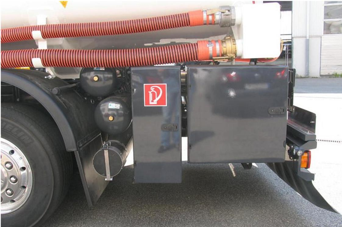
Aluminium-Kasten für 12 kg-Feuerlöscher und Zubehörkasten
