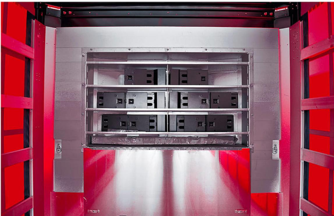
OPTIONAL: Keilekasten (Papier): Sicherungskeile für den Papierrollentransport sind in einem in der Vorderwand integrierten Kasten verstaut. Der Fahrer hat direkten Zugriff von der Ladefläche.
