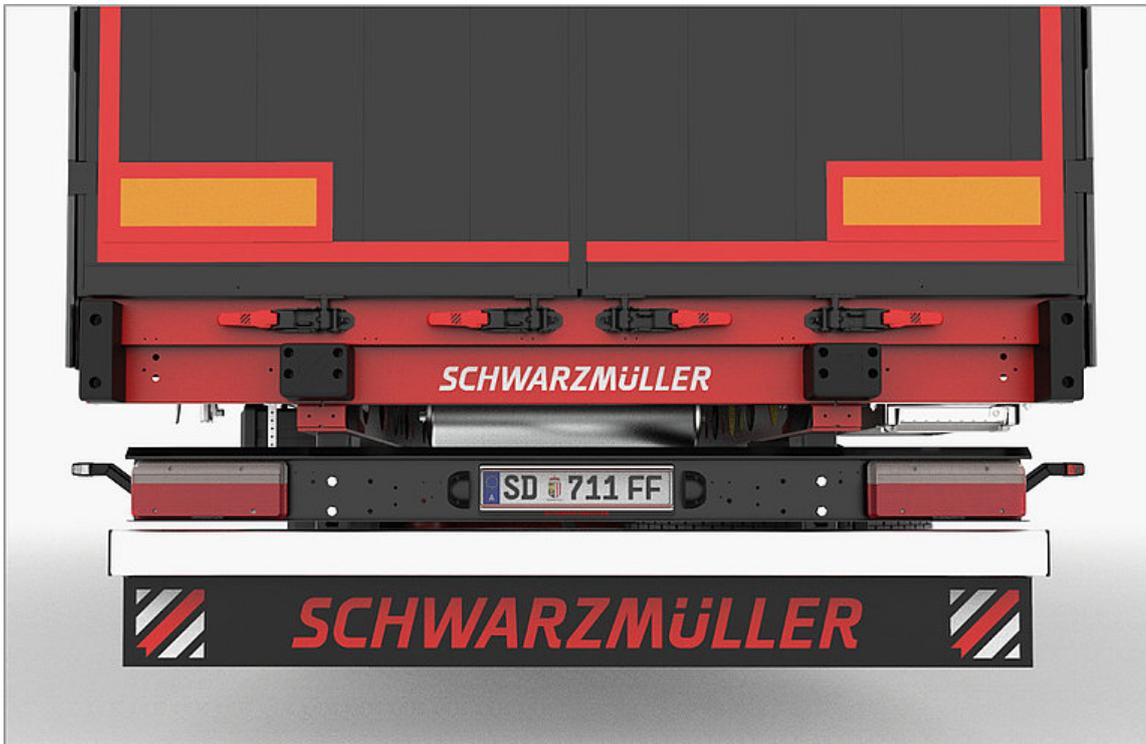
Unterfahrtschutz: Verhindert das Unterfahren des Fahrzeuges an der Rückseite und entspricht jetzt schon der neuen EU-Regelung ab 2021 mit erhöhten Prüfkräften.
