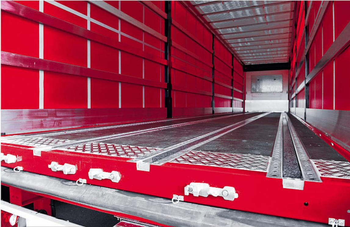
OPTIONAL: Einlagen für Joloda Schienen: Im General Cargo Einsatz werden die Schienen mit Kunststoff-Einlageprofilen abgedeckt bzw. aufgefüllt.
