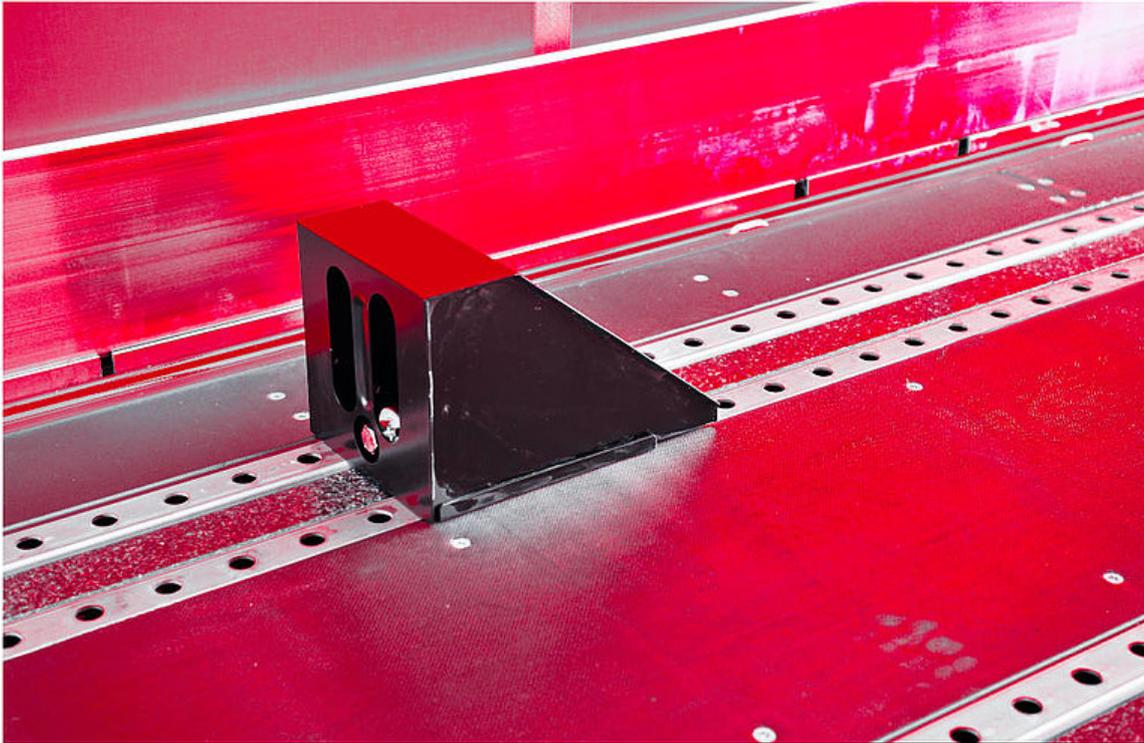
OPTIONAL: Ladungssicherungskeile und Joloda Roller: Mit Spindeln verstellbare Keile gewährleisten die Ladungssicherheit von Papierrollen. Ein Joloda Roller ermöglicht das einfache Be- bzw. Entladen der Papierrollen.
