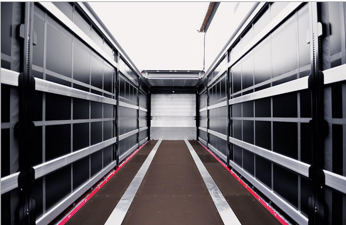
Kraftorientierter Siebdruckboden: 28 mm + 12 mm. (Staplerachslast: bis 8.000 kg).
