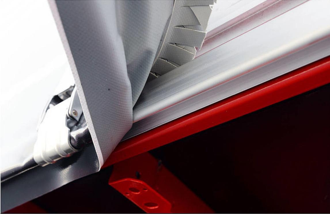
Planeneinhakleiste: Ermöglicht die senkrechte Fixierung der Seitenplane am Außenrahmen. Gewährleistet einen sauberen Abschluss, auch ohne eine schräge Befestigung der Spanner.
