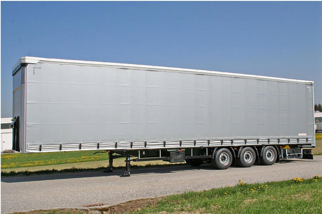
Korrosionsarme hochwertige Aluminium-Aufbaukomponenten, geprüft nach EN 12642
