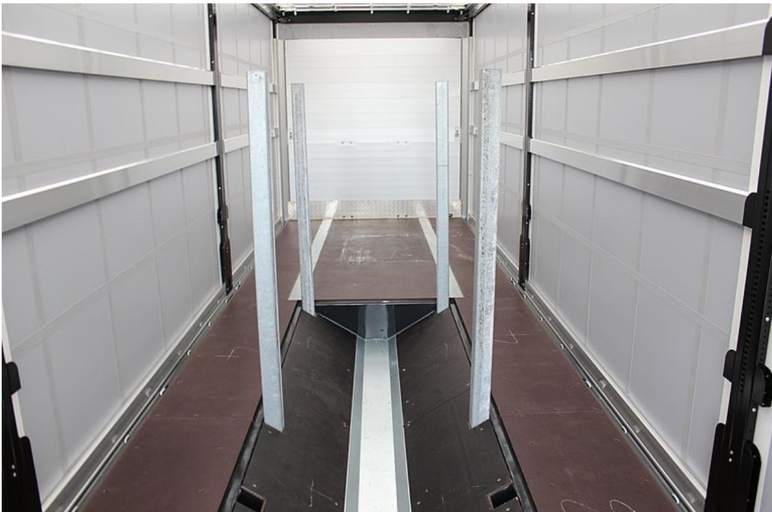
OPTIONAL: Coilmulde = Nutzlänge ca. 7.400 mm - Ausführung nach VDI 2700 für Coilsdurchmesser 900 bis max. 2.100 mm
