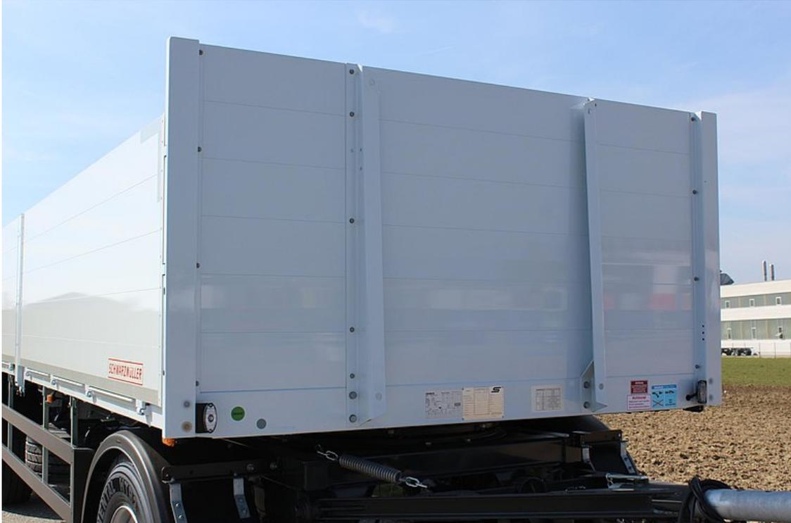
Fixe Aluminium-Hohlprofil-Vorderwand mit 2 Mittelstützen bis oben
