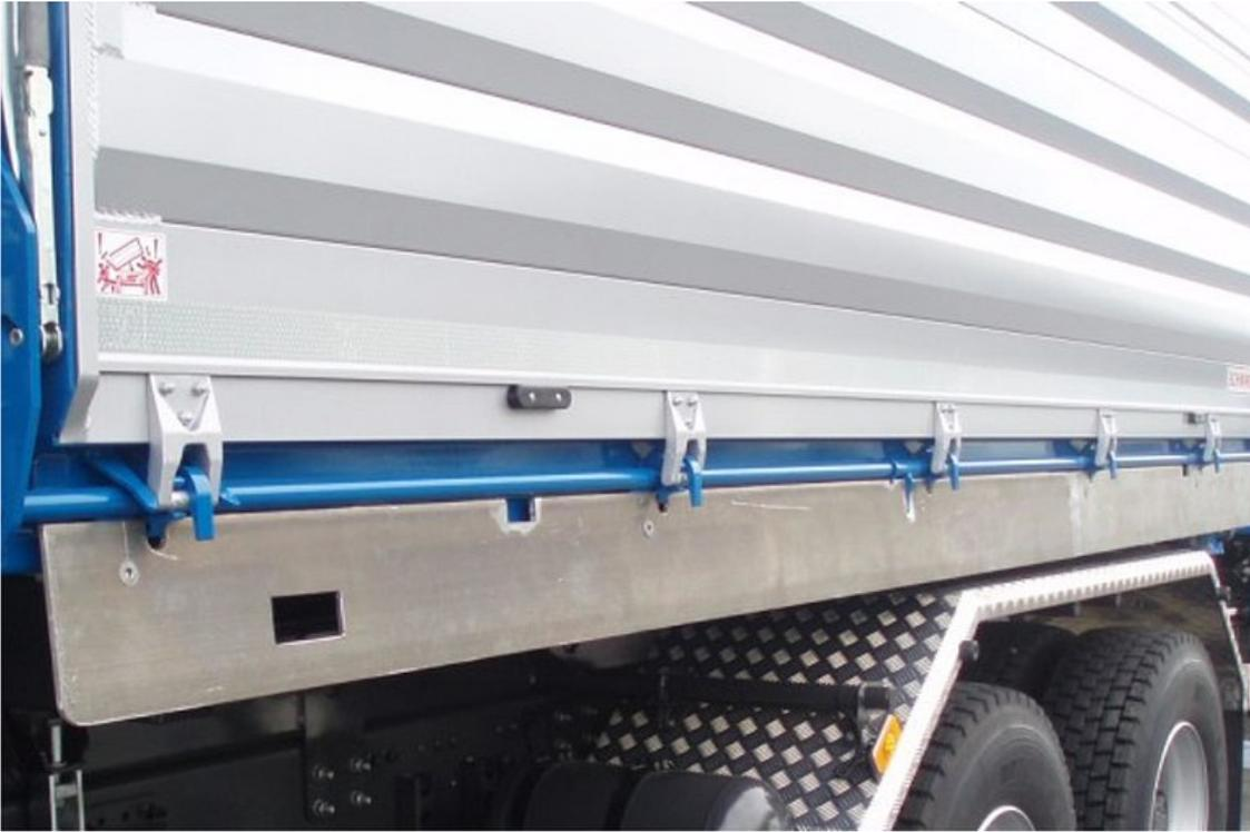
OPTIONAL: Aluminium-Klappe auf seitlicher Zentralverriegelungswelle
