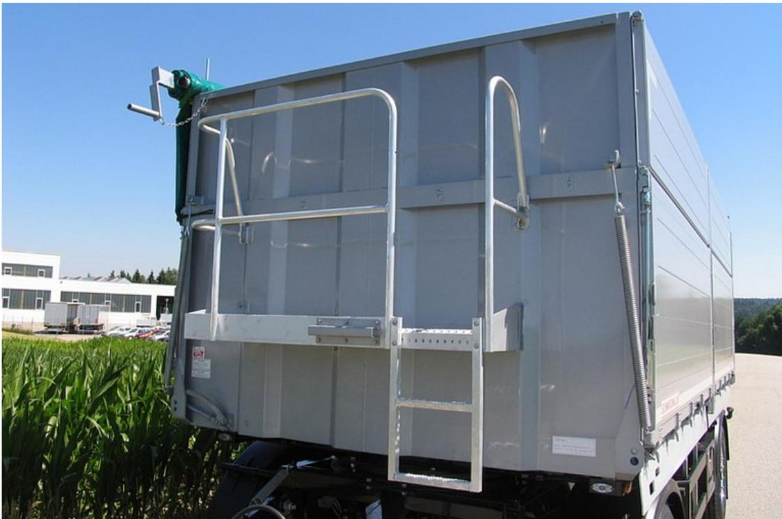
OPTIONAL: Stehpodest aus Aluminium-Sicherheitsrost mit Schutzgeländer und Aufstieg
