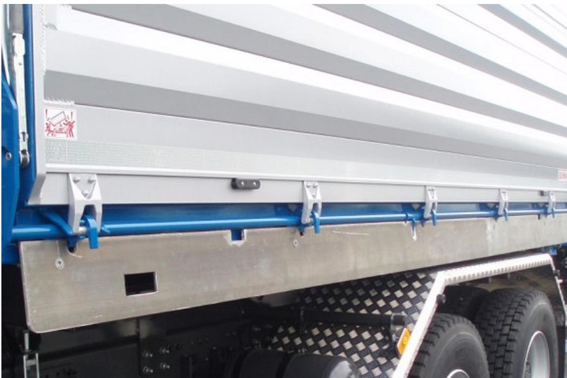
OPTIONAL: Aluminium-Klappe auf seitlicher Zentralverriegelungswelle
