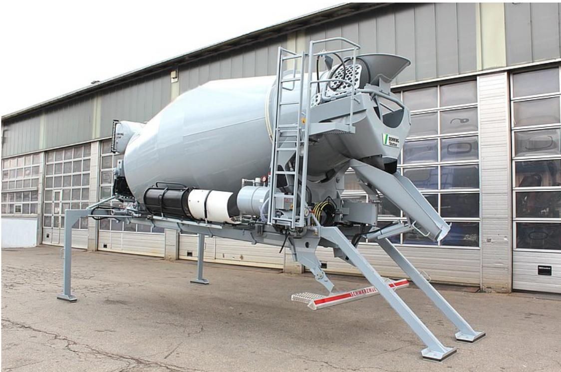
Betonmischer-Aufbau im abgestellten Zustand
