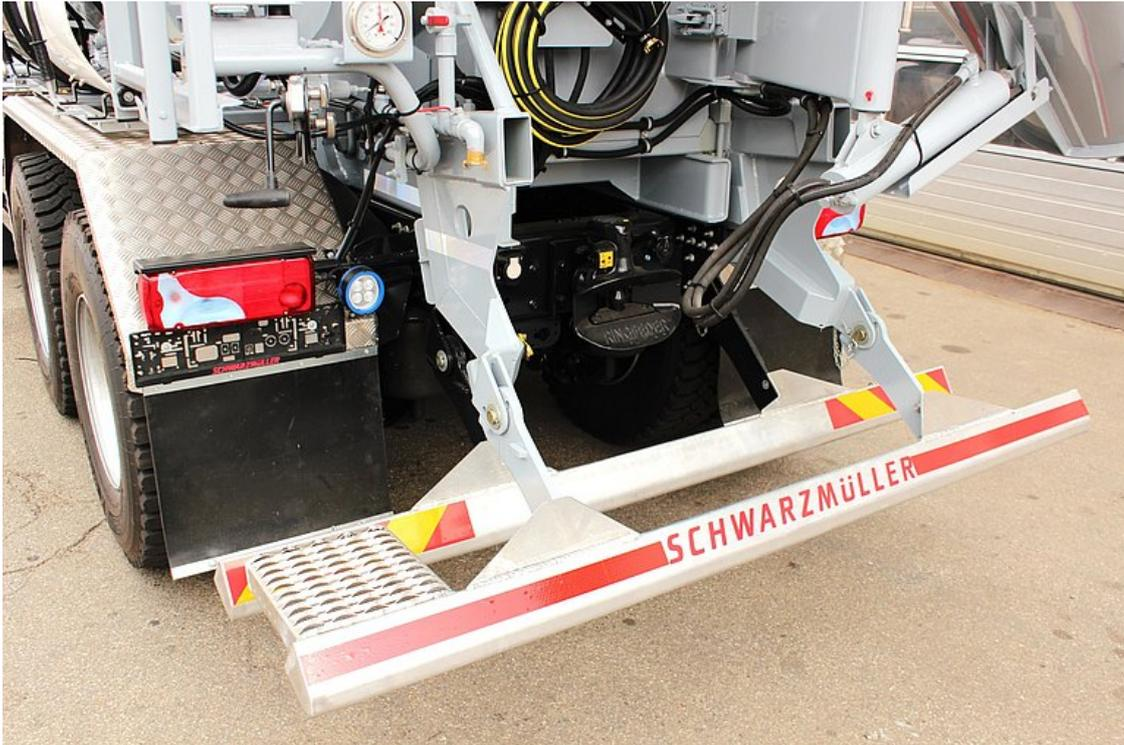
OPTIONAL: Unterfahrschutz klapp und abnehmbar
