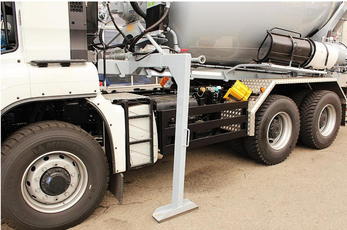
Vordere Abstützungen für ein schnelles und einfaches Wechseln des Aufbaus
