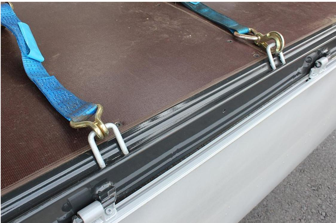
Zurrbügel-Außenrahmen mit versenkten 2,5 t Zurrbügel
