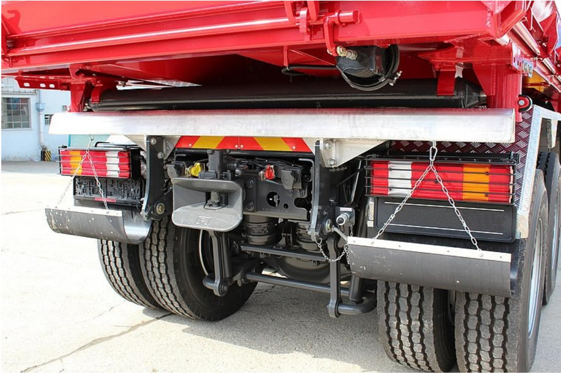
OPTIONAL: Aluminium-Unterfahrschutz hochklappbar für Fertigeresatz
