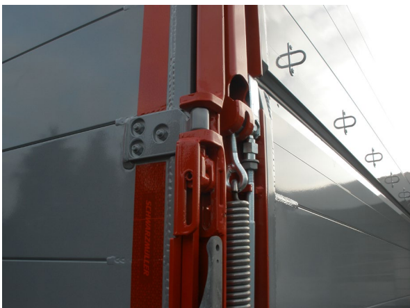
Ściana tylna z możliwością odchylenia: Wszystkie zamontowane elementy ruchome, takie jak zawiasy, zamki, sworznie, trzpienie itd. sprawdzić pod kątem zużycia i poprawności działania
