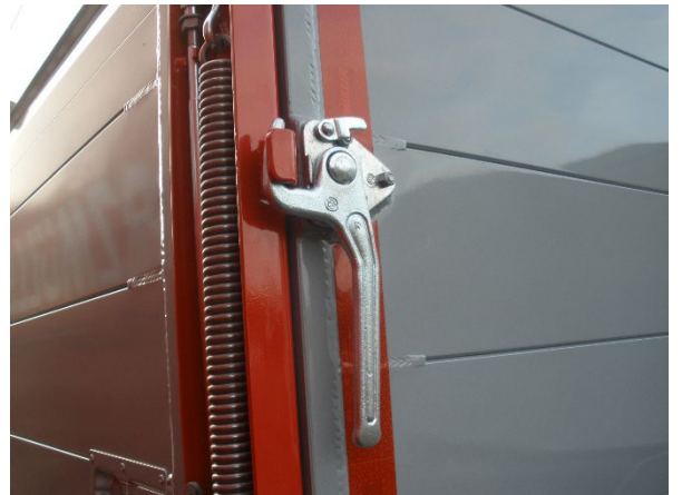
Zamek: sprawdzić pod kątem zużycia i prawidłowego działania
