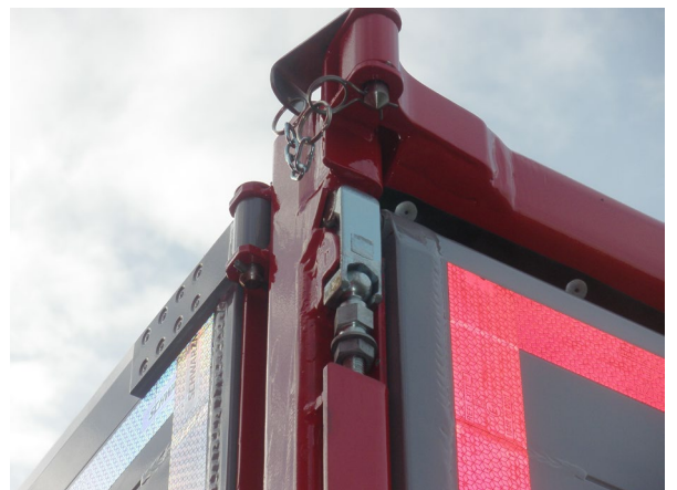
Ściana tylna z możliwością odchylenia: Wszystkie zamontowane elementy ruchome, takie jak zawiasy, zamki, sworznie, trzpienie itd. sprawdzić pod kątem zużycia i poprawności działania
