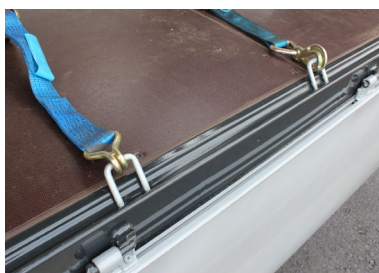
Różne warianty uchwyty do mocowania po bokach pokładu
