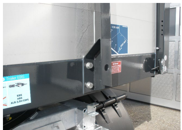
Sprawdzić trzymanie śrub mocujących wspornik ściany przedniej
