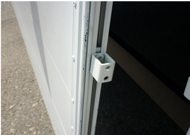
Sprawdzić trzymanie zapinacza i pod kątem uszkodzeń
