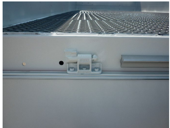
Sprawdzić zawiasy pod kątem poprawności działania i uszkodzeń Sworzeń zawiasu: sprawdzić spoiny pod kątem pęknięć
