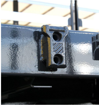
Uchwyt kłonicy: sprawdzić spoiny pod kątem pęknięć
