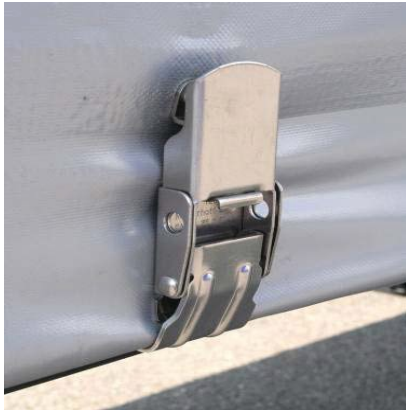
Bezpośredni napinacz plandeki: sprawdzić trzymanie nitów
