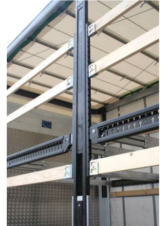
Środkowy słupek: sprawdzić mocowanie kieszeni na deski
