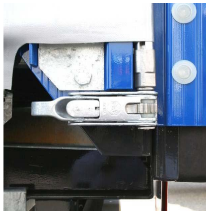
Tylny system naciągu: Sprawdzić poprawność działania, adapter drążka naciągu plandeki sprawdzić pod kątem uszkodzeń
