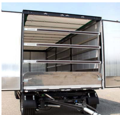
Belki poprzeczne i boczne szyny: sprawdzić trzymanie wszystkich śrub i nitów
