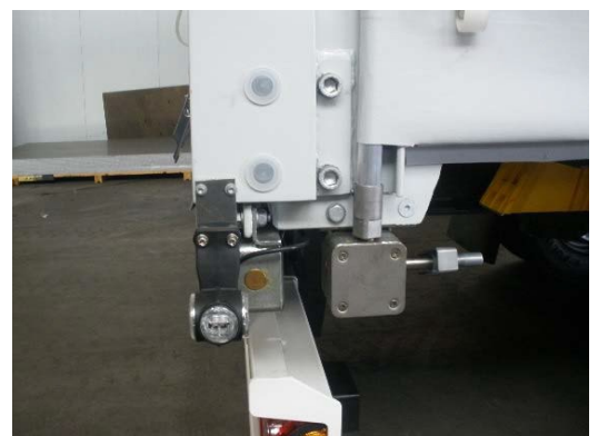
Tylny system naciągu: system naciągu sprawdzić pod kątem poprawności działania, adapter drążka naciągu plandeki sprawdzić pod kątem uszkodzeń
