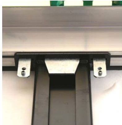
Wózek środkowych słupków: sprawdzić trzymanie nitów
