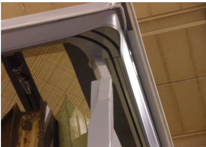
W wersji Edscha Eco w połączeniu ze stałą ścianą tylną: miejsce łączenia narożnego słupka i łuku sprawdzić pod kątem uszkodzeń, pęknięć spoiny itp.
