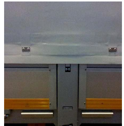
Napinacz Quick-Slide: sprawdzić trzymanie nitów, sprawdzić pasy i elementy napinające pod kątem uszkodzeń i pęknięć
