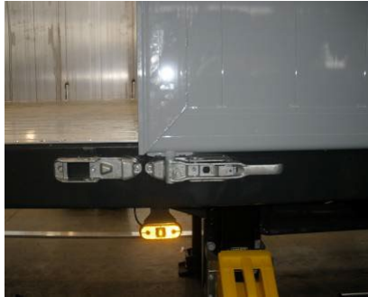
Zárak fent és lent: csavarok megfelelő rögzítettségének ellenőrzése
