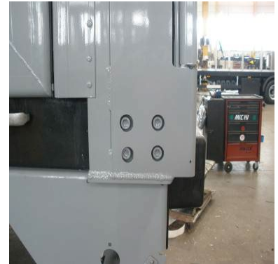
Oszlopok hátul: csavarok megfelelő rögzítettségének ellenőrzése
