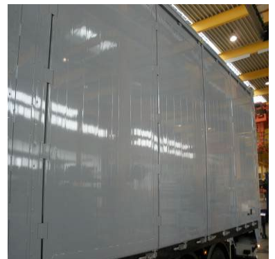
Ajtók az oldalfalnál: zsanérok megfelelő működésének ellenőrzése, valamint, hogy van-e rajtuk sérülés. Zsanérház rögzítettségének ellenőrzése, valamint van-e rajta sérülés
