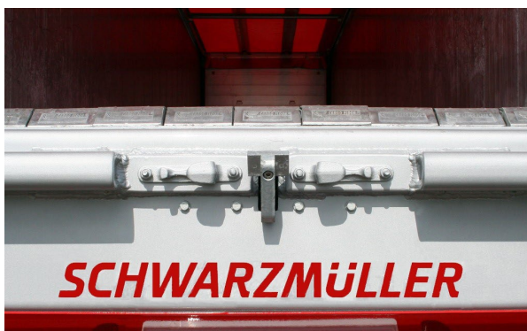
Hátsó ajtó alul: a zárcsapon van-e sérülés, csavarok megfelelő rögzítettsége
