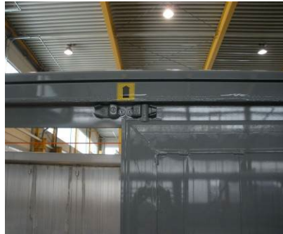
Zárak fent és lent: csavarok megfelelő rögzítettségének ellenőrzése
