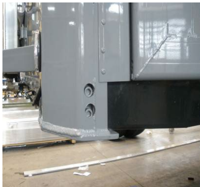
Oszlopok elől: csavarok megfelelő rögzítettségének ellenőrzése
