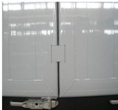
Ajtók az oldalfalnál: zsanérok megfelelő működésének ellenőrzése, valamint, hogy van-e rajtuk sérülés. Zsanérház rögzítettségének ellenőrzése, valamint van-e rajta sérülés
