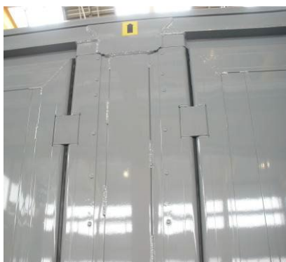
Középoszlopok: szegecsek megfelelő rögzítettségének ellenőrzése. Zsanérok működésének ellenőrzése, valamint van-e rajta sérülés, zsanérház rögzítettségének ellenőrzése, valamint van-e rajta sérülés
