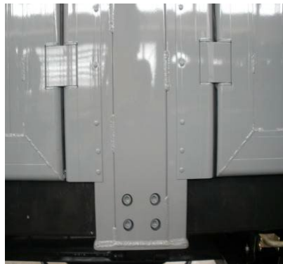
Középoszlopok: csavarok megfelelő rögzítettségének ellenőrzése
