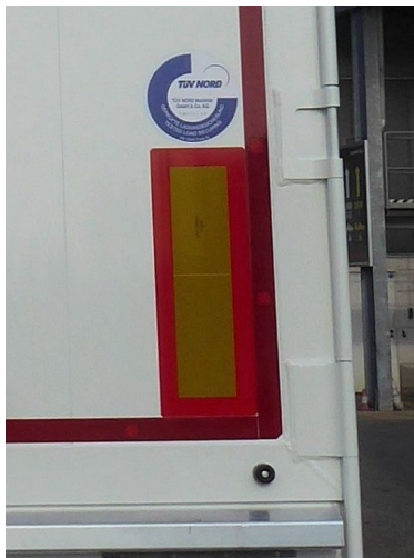
Zsanérok megfelelő működésének ellenőrzése, valamint, hogy van-e rajtuk sérülés. Zsanérház rögzítettségének ellenőrzése, valamint, hogy van-e rajta sérülés
