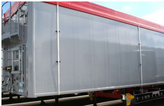
Oldalfal kívül és belül: hegesztési varratok ellenőrzése, van-e rajta repedés
