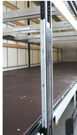
Középoszlopok oldalt lent: szegecsek megfelelően rögzítettek-e
