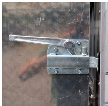
Zárak és zárbetétek: Ellenőrizni kell minden szegecs és csavar megfelelő rögzítettségét
