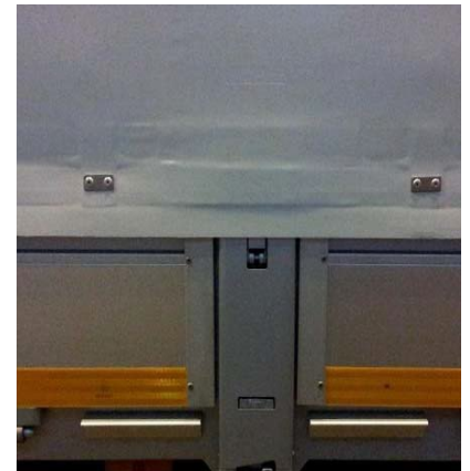
Quick-Slide-feszítő: szegecsek rögzítettsége, hevederek és feszítőelemek: van-e rajtuk sérülés vagy repedés
