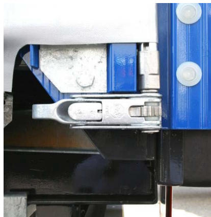
Hátsó feszítőmű: megfelelő működés ellenőrzése, ill. a ponyvafeszítő rúd adapterén van-e sérülés
