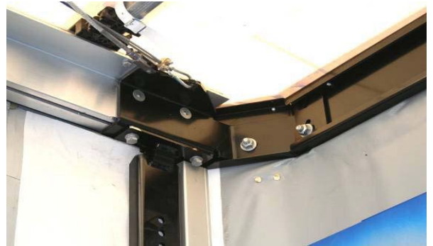
Tető elől: csavarok megfelelő rögzítettségét ellenőrizni
