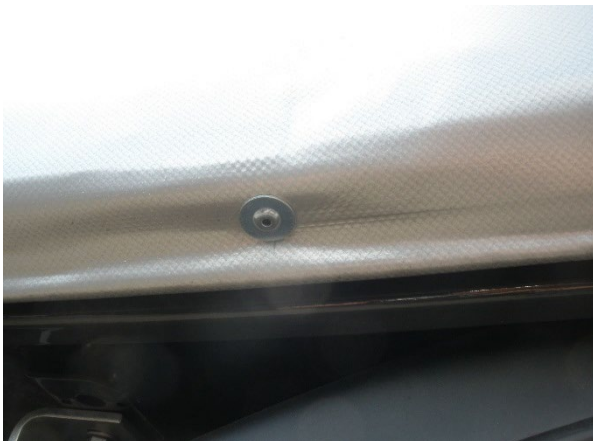
Alsó ponyvarögzítő szegecsek rögzítettségét ellenőrizni
