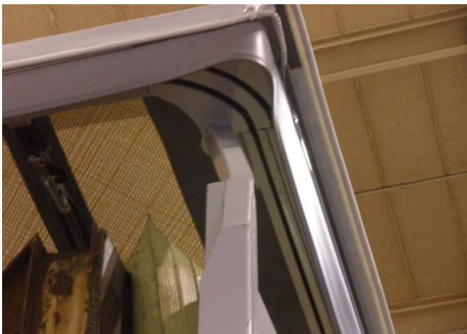
Edscha Eco esetén, fix hátsó ajtóval: az összekötőt a hátsó oszlopnál, valamint az ívelemet ellenőrizni, van-e rajta sérülés, a hegesztésnél repedés stb.
