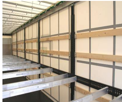
Oldalponyva: az erősítő hevederek ellenőrzése, a hegesztési varraton van-e repedés, sérülés
