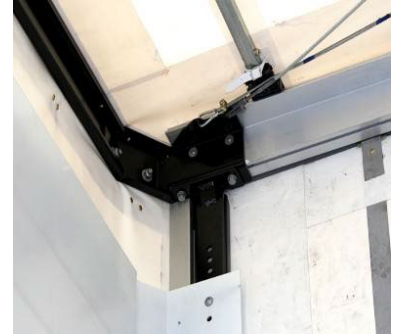
Első sarokoszlopok: Szegecsek és csavarok megfelelő rögzítettségét ellenőrizni
