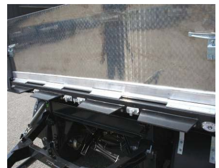
Ellenőrizni kell a zsanérok csavarjainak megfelelő rögzítettségét
