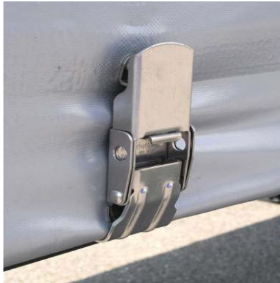
Direktfeszítő: szegecsek megfelelő rögzítettsége
