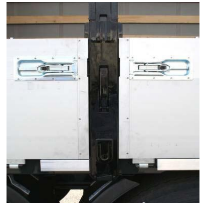
Oldalajtó: szegecsek megfelelő rögzítettsége
