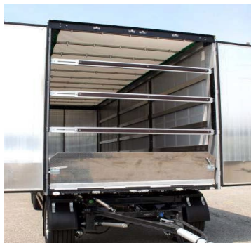
Keresztgerendák és oldalsínek: Ellenőrizni kell minden szegecs és csavar megfelelő rögzítettségét
