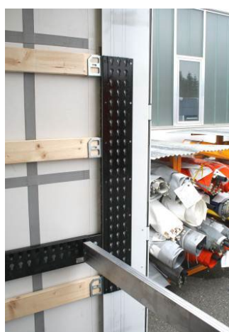
Hátsó sarokoszlopok: sínek szegecseinek ellenőrzése, megfelelően rögzítettek-e
