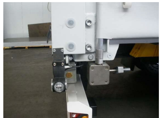
Hátsó feszítőmű: feszítőmű megfelelő működése ill. a ponyvafeszítő rúd adapterén van-e sérülés
