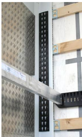
Első sarokoszlopok: sínek szegecseinek ellenőrzése, megfelelően rögzítettek-e
