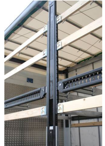
Középoszlopok: léctartó zsebek rögzítettségének ellenőrzése
