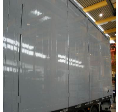
Vrata na boční stěně: zkontrolovat řádnou funkčnost závěsů a příp. poškození, zkontrolovat řádné upevnění závěsů a případná poškození.
