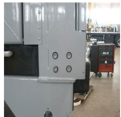
Zadní sloupky: zkontrolovat upevnění šroubů.
