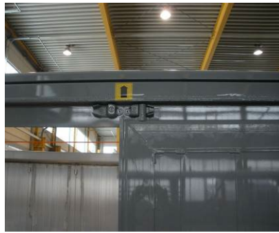
Uzávěry a zámky nahoře a dole: zkontrolovat upevnění šroubů.
