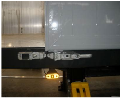
Uzávěry a zámky nahoře a dole: zkontrolovat upevnění šroubů.
