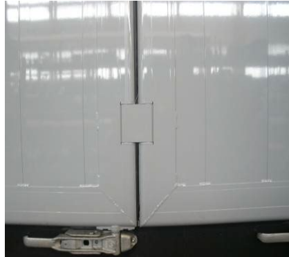
Vrata na boční stěně: zkontrolovat řádnou funkčnost závěsů a příp. poškození, zkontrolovat řádné upevnění závěsů a případná poškození.
