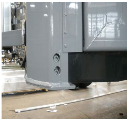
Přední sloupky: zkontrolovat upevnění šroubů.
