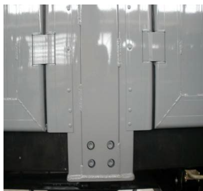
Středové sloupky: zkontrolovat upevnění šroubů.
