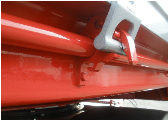
Centrální uzavírání: vizuální kontrola opotřebení, vůle a upevnění šroubů.
