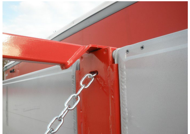
Provázání středových sloupků řetězem: vizuální kontrola celkového stavu.
