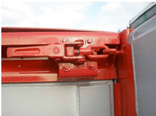
Uzavírání horního příčnicku zadního čela: zkontrolovat funkčnost a pevnost.
