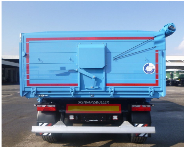
Zadní stěna: zkontrolovat svary na praskliny.
