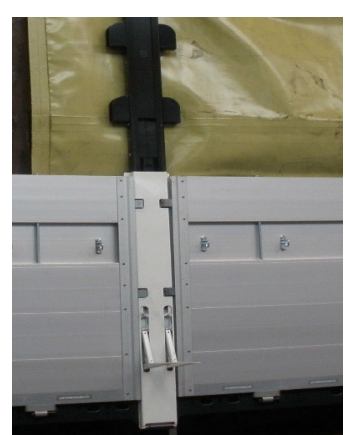
Bočnice: zkontrolovat upevnění nýtů a uzávěrů.
