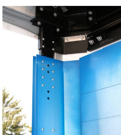
Přední rohové sloupky: zkontrolovat upevnění nýtů.
