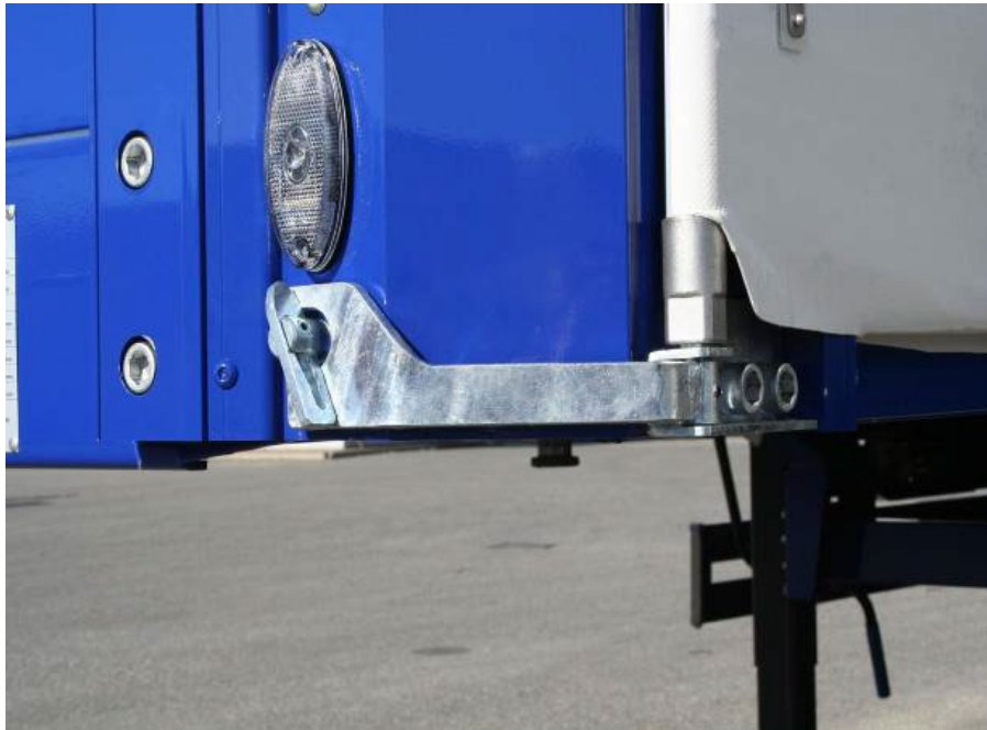
Rychlouzávěr vpředu: zkontrolovat jeho upevnění a řádnou funkčnost. Zkontrolovat adaptér napínací tyče plachty na poškození.
