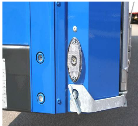
Rohové sloupky: zkontrolovat upevnění nýtů a šroubů.
