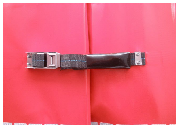
Vertikální přehyb plachty: zkontrolovat napínáky na poškození a jejich správnou funkčnost.
