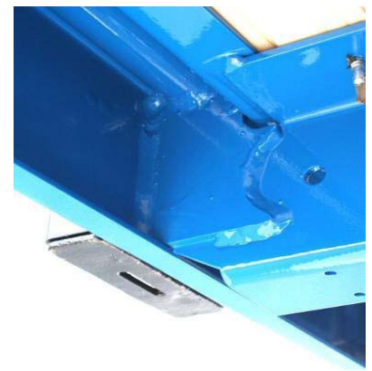
Uložení sloupku zevnitř: zkontrolovat svary na praskliny.
