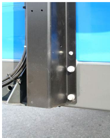
Držák přípojů: zkontrolovat upevnění nýtů a šroubů.
