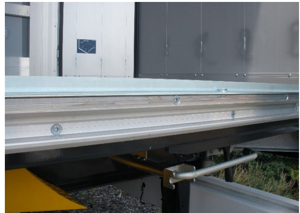
Zkontrolovat funkčnost a stav opotřebení vodicích kolejnic ve spodní části. Zkontrolovat upevnění všech šroubů.
