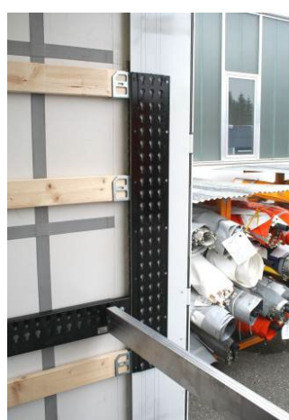
Rohové sloupky vzadu: zkontrolovat upevnění nýtů lišty.
