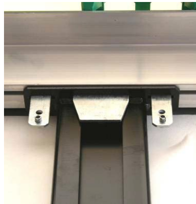
Pojezdy středových sloupků: zkontrolovat upevnění nýtů.
