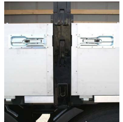
Bočnice: zkontrolovat upevnění nýtů a uzávěrů.
