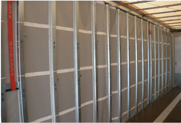
Vizuální kontrola Quick Slideru na plastickou deformaci.
