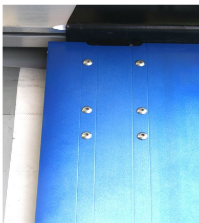
Zadní rohové sloupky: zkontrolovat upevnění nýtů.
