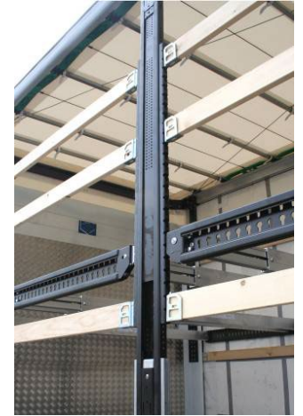
Středové sloupky: zkontrolovat upevnění kapes pro latě.
