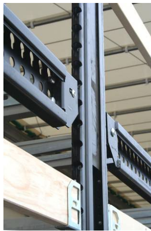
Boky středových sloupků: zkontrolovat upevnění všech nýtů a šroubů.
