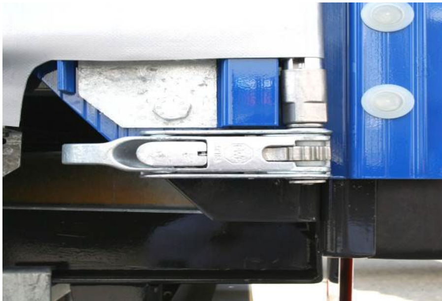
Napínací převodovka vzadu: zkontrolovat její řádnou funkčnost. Zkontrolovat adaptér napínací tyče plachty na poškození.
