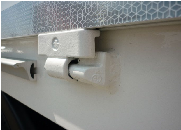
Závěsy: zkontrolovat řádnou funkčnost a stav opotřebení. Uchytení závěsů: zkontrolovat svary na praskliny.
