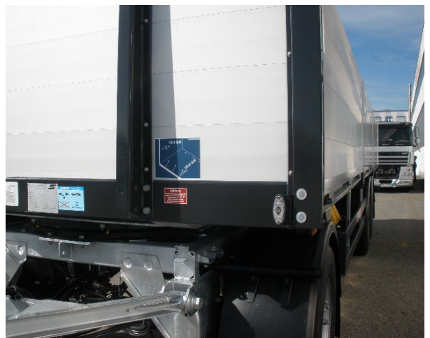
Držák přípojů: zkontrolovat upevnění nýtů a šroubů.
