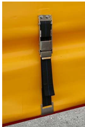
Plochý napínák: zkontrolovat upevnění nýtů a příp. poškození popruhu.
