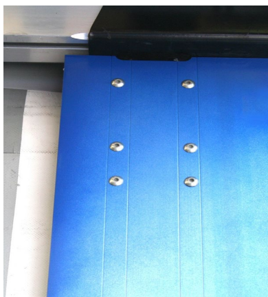
Zadní rohové sloupky: zkontrolovat upevnění nýtů.
