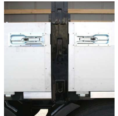
Bočnice: zkontrolovat upevnění nýtů.
