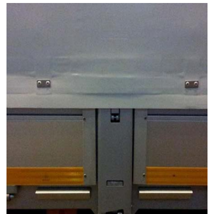
Quick-Slide-napínák: zkontrolovat upevnění nýtů, popruhů a napínacích prvků na poškození a praskliny.
