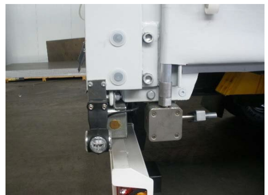
Napínací převodovka vzadu: zkontrolovat její řádnou funkčnost a zkontrolovat adaptér napínací tyče plachty na poškození.
