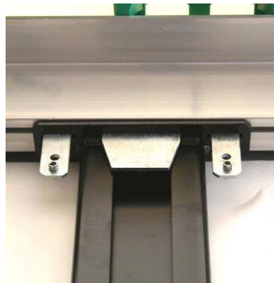
Pojezdy středových sloupků: zkontrolovat upevnění nýtů.
