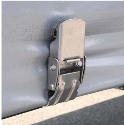
Napínák (direkt): zkontrolovat upevnění nýtů.
