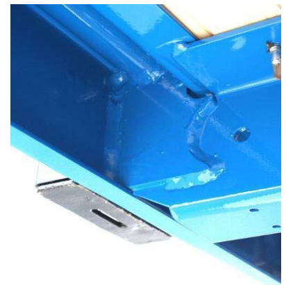
Uložení sloupku zevnitř: zkontrolovat svary na praskliny.
