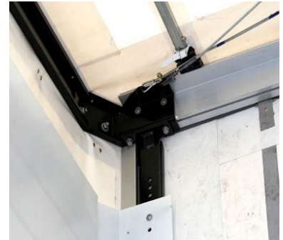
Rohové sloupky vpředu: zkontrolovat upevnění všech nýtů a šroubů.
