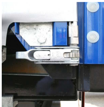
Napínací převodovka vzadu: zkontrolovat její řádnou funkčnost, zkontrolovat adaptér napínací tyče plachty na poškození.
