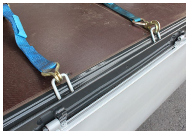
Nejrůznější provedení upínacích třmenů po stranách podlahy.
