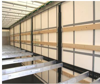
Boční plachta: zkontrolovat svary zesilujících popruhů na praskliny a příp. jiná poškození.
