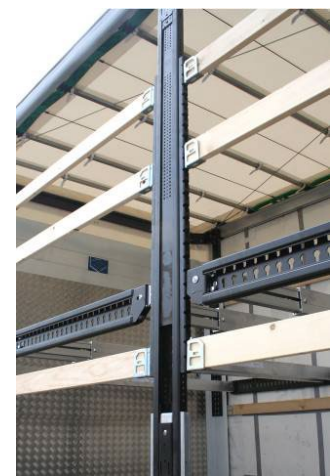
Středové sloupky: zkontrolovat upevnění kapes pro latě.
