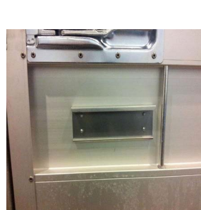
Quick-Slide-uzávěr: zkontrolovat upevnění nýtů.
