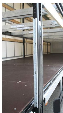
Boky středových sloupků ve spodní části: zkontrolovat upevnění nýtů a šroubů.
