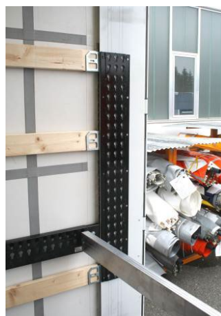
Rohové sloupky vzadu: zkontrolovat upevnění nýtů lišty.
