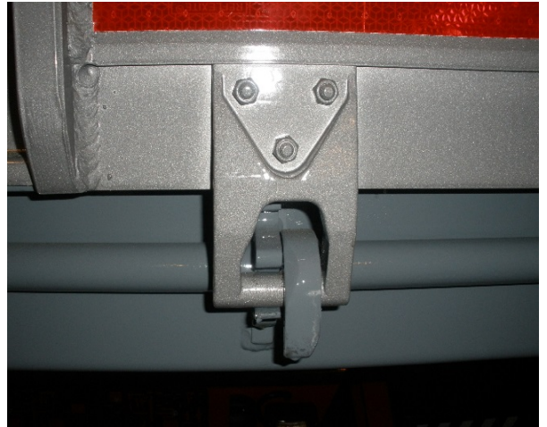
Scharniere: Schweißnähte auf Risse prüfen, Schrauben auf Festsitz prüfen
