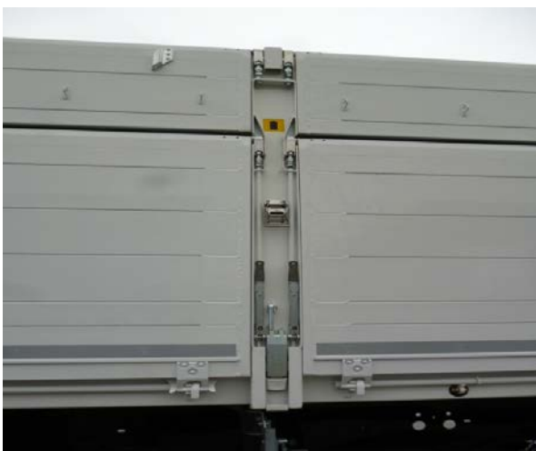
Vorderwand, Mittelsäule(n) und Ecksäulen hinten: Funktion der Verriegelung prüfen
