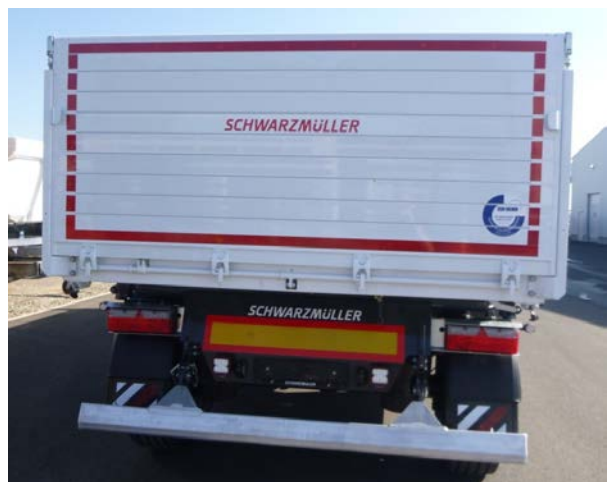
Rückwand zusätzlich schwenkbar: Alle beweglichen Anbauteile wie Scharniere, Verschlüsse, Bolzen, Zapfen etc. auf Verschleiß und Funktion prüfen
