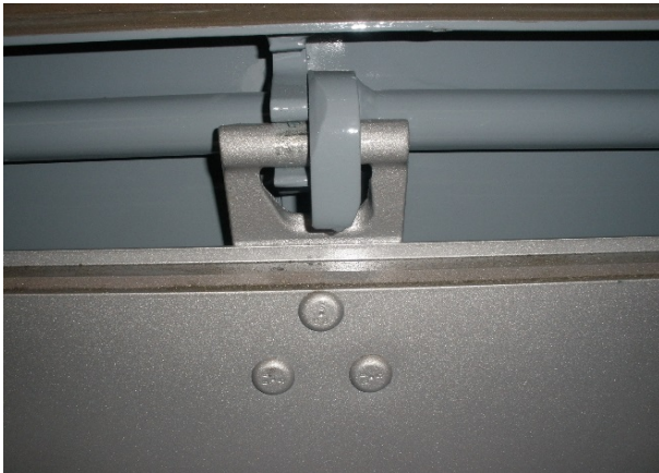
Zentralverriegelung: Sichtprüfung auf Abnützung, Spiel etc.
