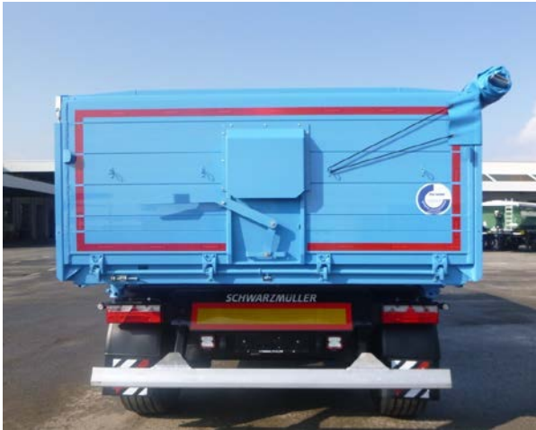
Rückwand: Schweißnähte auf Risse prüfen
