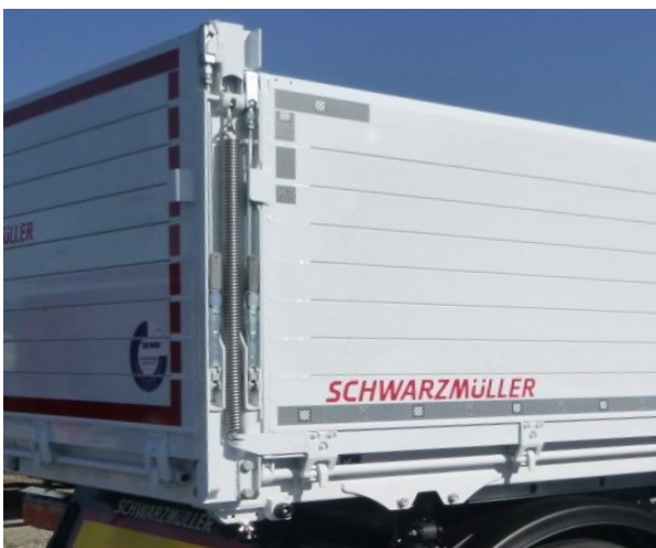
Rückwand zusätzlich schwenkbar: Alle beweglichen Anbauteile wie Scharniere, Verschlüsse, Bolzen, Zapfen etc. auf Verschleiß und Funktion prüfen
