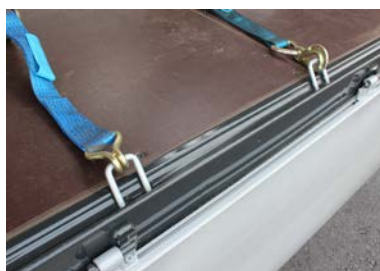
Verschiedenste Ausführungen von Zurrbügeln seitlich am Plateau
