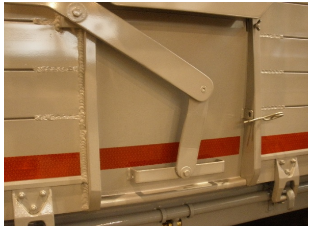
Rückwand: Schweißnähte auf Risse prüfen
