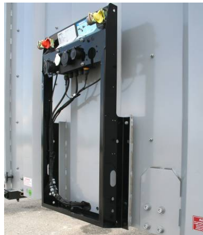
Gerätehalter: Alle Nieten und Schrauben auf Festsitz prüfen
