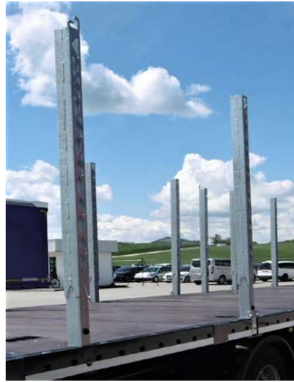
Gesamte Rungen und Rungenlager: Schweißnähte auf Risse prüfen
