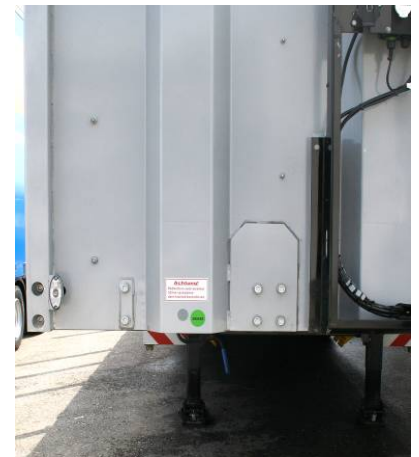
Vorderwand unten: Schraubverbindungen auf Festsitz prüfen
