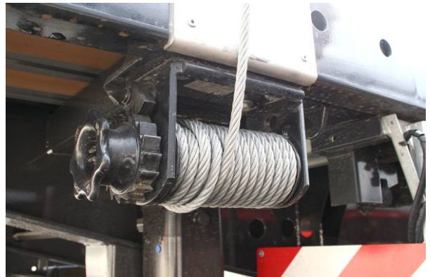
Seilspannrollen: Auf Funktion und ordnungsgemäße Befestigung prüfen
