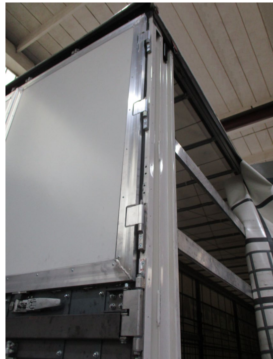
Querriegelungsbolzen (1) und -betätigung (2) auf Verschleiß, Beschädigungen und Funktion prüfen
