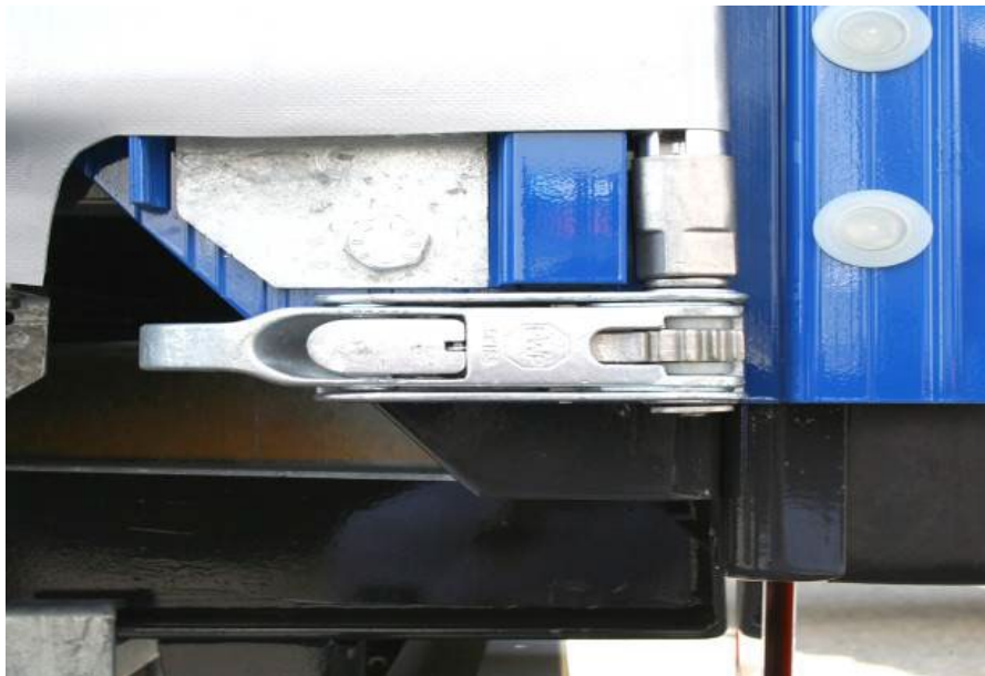
Spanngetriebe hinten: Auf ordnungsgemäße Funktion prüfen, Adapter für Planen-Spannrohr auf Beschädigungen prüfen
