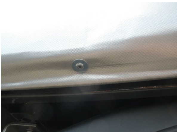
Vernietung der Seitenplane unten auf Festsitz prüfen
