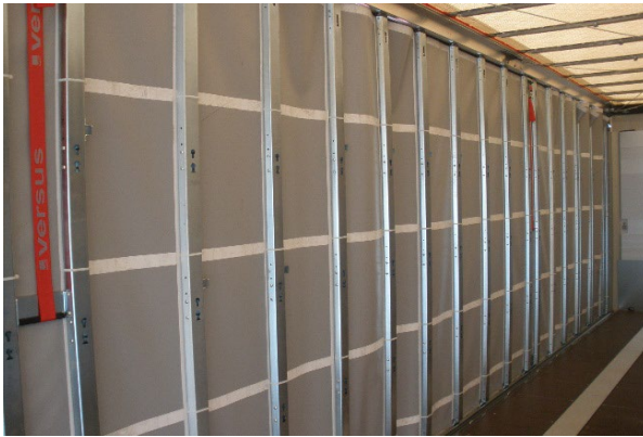
Quick Slider Sichtprüfung auf plastische Verformung etc.
