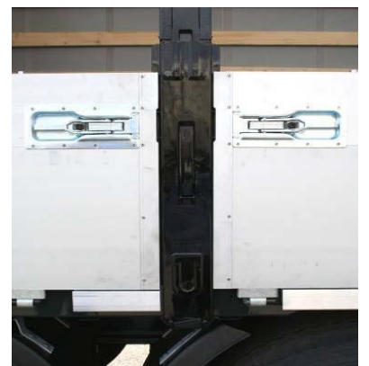
Bordwände: Nieten auf Festsitz prüfen, Verschlüsse auf Festsitz prüfen
