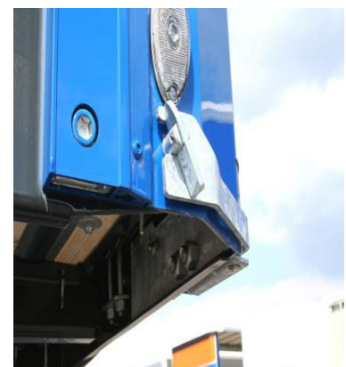
Ecksäule: Alle Nieten und Schrauben auf Festsitz prüfen
