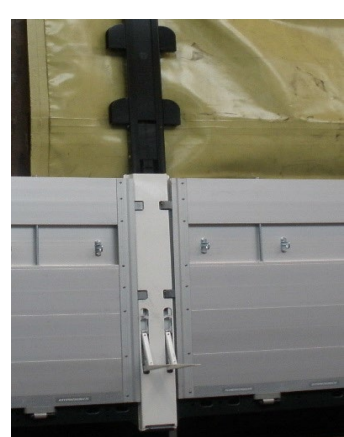
Bordwände: Nieten auf Festsitz prüfen, Verschlüsse auf Festsitz prüfen
