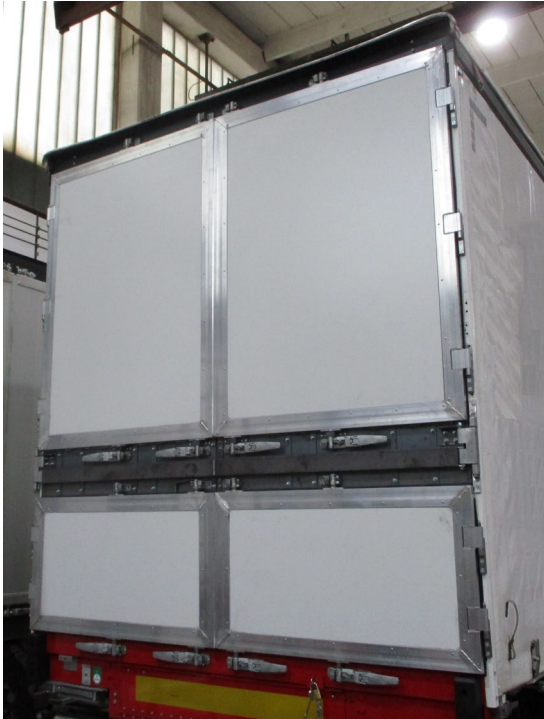
Alle Nieten und Schrauben auf Festsitz prüfen
