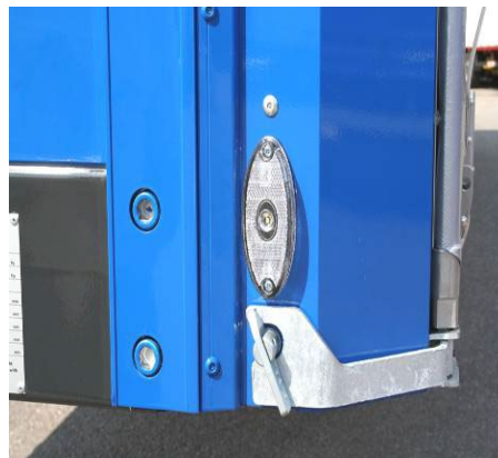
Ecksäule: Alle Nieten und Schrauben auf Festsitz prüfen
