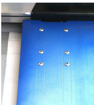
Ecksäulen hinten: Nieten auf Festsitz prüfen
