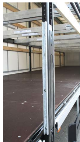
Mittelsäulen seitlich unten: Nieten auf Festsitz prüfen
