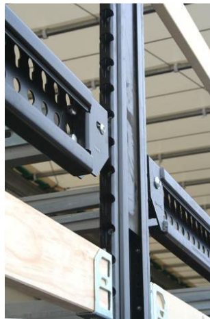
Mittelsäulen seitlich: Nieten der Schiene auf Festsitz prüfen
