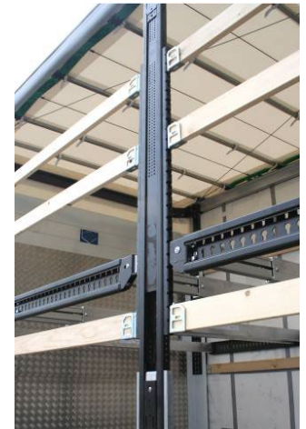
Mittelsäule: Befestigung der Lattentaschen prüfen
