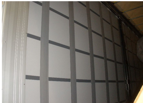
Rola-Safe Schiebeplane: Stahlbänder auf Verformung prüfen
