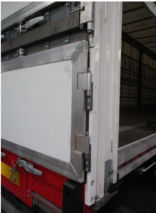
Scharniere auf ordnungsgemäße Funktion und Beschädigungen prüfen Scharnierbefestigungen auf Beschädigungen und Festsitz prüfen
