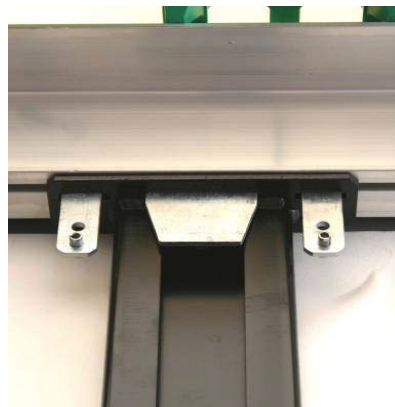
Laufwagen der Mittelsäulen: Nieten auf Festsitz prüfen
