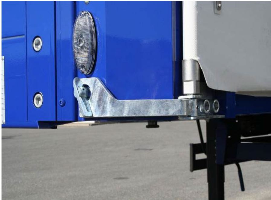
Schnellverschluss vorne: Befestigung und ordnungsgemäße Funktion prüfen. Adapter für Planen-Spannrohr auf Beschädigungen prüfen
