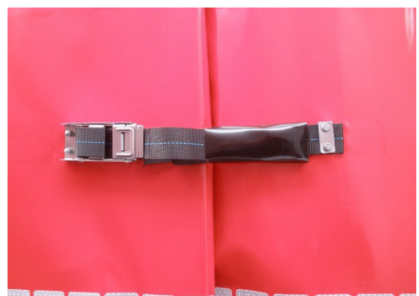
Planenfalte vertikal: Spanner auf Beschädigungen und ordnungsgemäße Funktion prüfen
