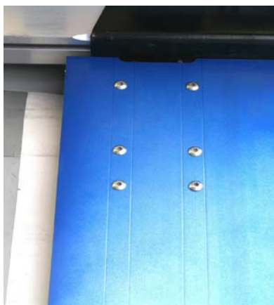
Ecksäulen hinten: Nieten auf Festsitz prüfen
