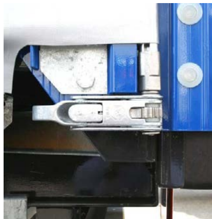
Spanngetriebe hinten: Auf ordnungsgemäße Funktion prüfen, Adapter für Planen-Spannrohr auf Beschädigungen prüfen
