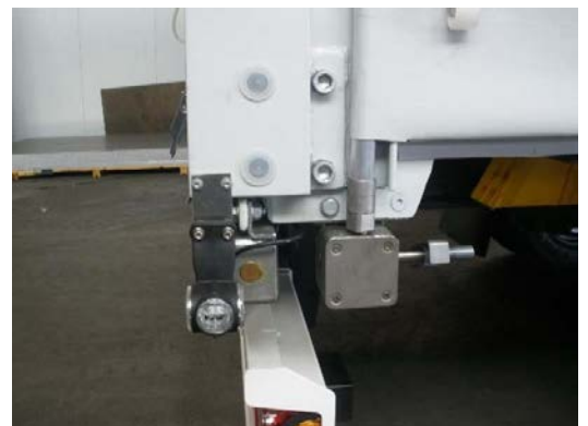
Spanngetriebe hinten: Auf ordnungsgemäße Funktion prüfen, Adapter für Planen-Spannrohr auf Beschädigungen prüfen
