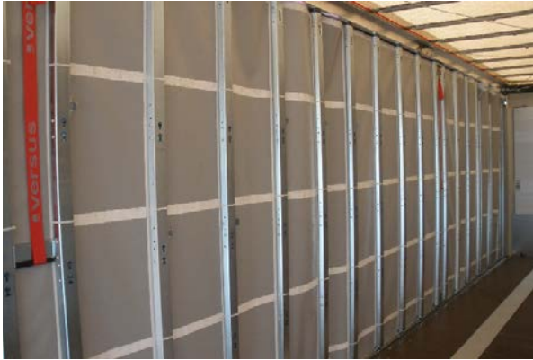
Quick Slider Sichtprüfung auf plastische Verformung etc.
