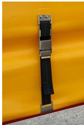
Flachhaken: Nieten auf Festsitz u. Gurt auf Beschädigung prüfen
