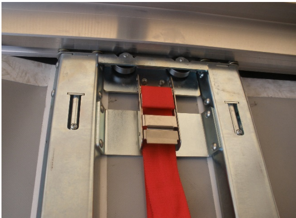
Laufwagen oben und unten auf Funktion und Verschleiß prüfen. Alle Nieten und Schrauben auf Festsitz prüfen
