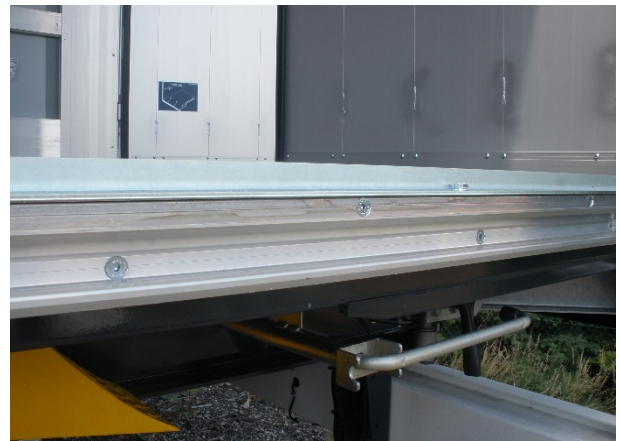
Führungsschiene unten auf Funktion und Verschleiß prüfen, Schraubverbindungen auf Festsitz prüfen.
