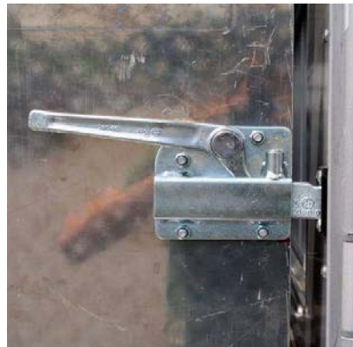
Verschlüsse und Verschlussaufnahmen: Alle Nieten und Schrauben auf Festsitz prüfen
