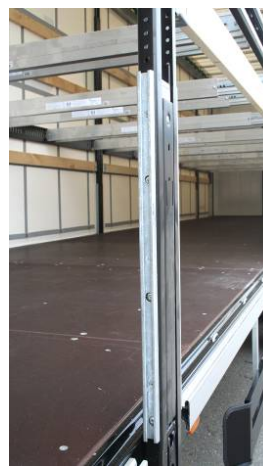
Mittelsäulen seitlich unten: Nieten auf Festsitz prüfen
