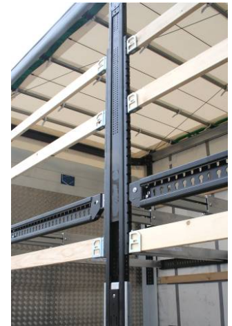
Mittelsäule: Befestigung der Lattentaschen prüfen
