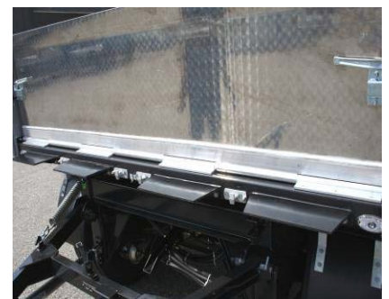
Schrauben der Scharniere auf Festsitz prüfen
