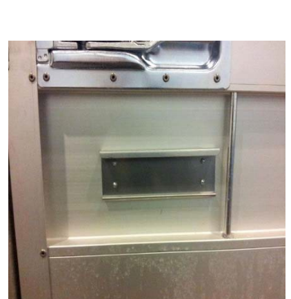
Quick-Slide-Verschluss: Nieten auf Festsitz prüfen
