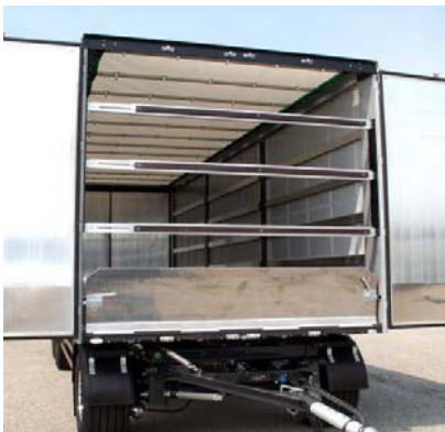
Querbalken und seitliche Schienen: Alle Nieten und Schrauben auf Festsitz prüfen
