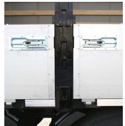
Bordwände: Nieten auf Festsitz prüfen
