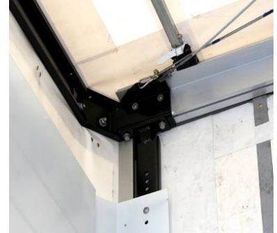
Ecksäule vorne: Alle Nieten und Schrauben auf Festsitz prüfen
