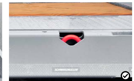
11 10 tonnás rögzítőgyűrűk A kihajtható rögzítőgyűrűk a rakomány rögzítésére szolgálnak.
