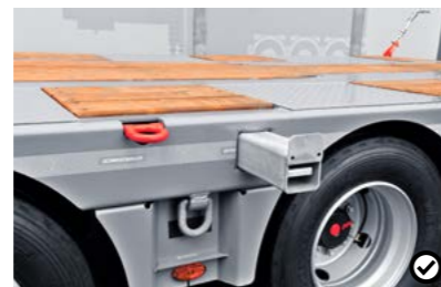
5 Kihúzható szélesítés A rakománytartók akár 3 méter szélességig kihúzhatók, mely lehetővé teszi a szélesebb járművek szállítását.
