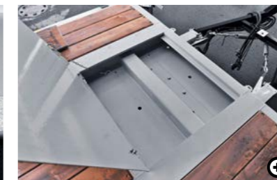
13 Tárolórekesz a tartozékoknak A plató első részében található tárolórekesz tartozékok és szerszámok szállítására használható.
