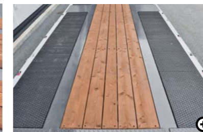
10 Vörösfenyő padló A rakfelület vörösfenyő padlóval van ellátva. Opcionálisan keményfa padló is választható.
