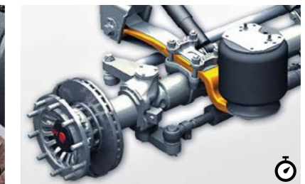
14 Kormányzott tengely Kormányzott tengely a pótkocsi jobb kormányozhatósága érdekében ill. a gumikopás csökkentésére. Talajkormányzott vagy hidraulikusan kényszerkormányzott tengely választható.
