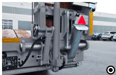
4 Lehajtható lábak a rámpákon A rámpa lenyitáskor a lehajtható lábak automatikusan lenyílnak, ezáltal megakadályozzák, hogy a pótkocsi eleje berakodáskor megemelkedjen.
