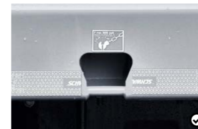
12 3 tonnás rögzítógombok A rögzítógombok, a rögzítőgyűrűkhöz hasonlóan a rakomány rögzítésére szolgálnak.
