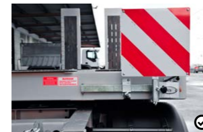
7 Kihúzható figyelmeztető táblák A jármű szélességének jelölésére szolgálnak, hogy a túl széles járművek szállítása biztonságos módon történhessen.
