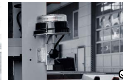
8 Forgólámpa tartóval A forgólámpa a közlekedés többi résztvevőjét figyelmezteti pl. különleges szállítmányok esetén.
