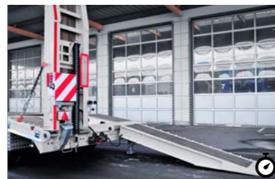
2 Egyrészes lehajtható rámpa A rakfelületre történő felhajtáshoz az egyrészes rámpa lehajtható.
