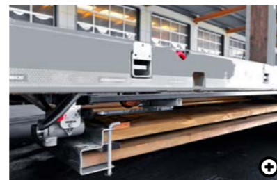
6 Tárolórekesz a szélesítéshez tartozó pallóknak A rakfelület kiszélesítéséhez használható fapallók a rakfelület alatti tárolórekeszben vannak elhelyezve.
