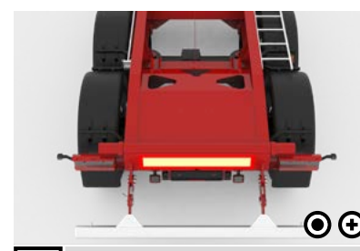
4 Egy részről álló billentő tengely A billentő tengely nem csak oldalt, hanem teljes hosszában be van hegesztve. Ez a billentés közben nagyobb stabilitást biztosít.
