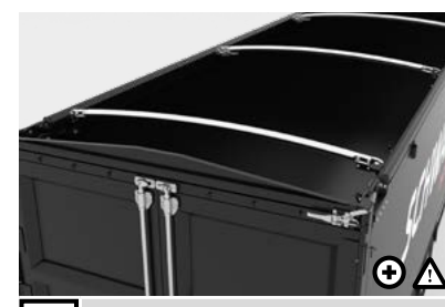
14 Tetőív A sima felületű, kör keresztmetszetű tetőívek plusz stabilitást adnak a puttonyoknak. Pakolásnál oldalra kifordíthatók, valamint csökkenti egy vízpárna kialakulásának az esélyét.
