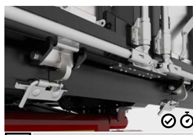
5 Automatikus billenő zár A hátsó ajtót egy különleges rudazat billentéskor automatikusan nyitja. A puttony visszahúzóedésekor a zárás is automatikusan történik.
