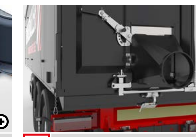
Q Tölcsér A levehető tölcsér a gabona megvezetésére szolgál, párhuzamos és kónuszos kialakításban elérhető.
