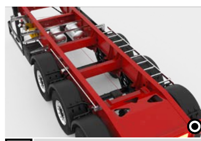
2 Torziós csövek Ezek a különleges keresztartók a torziós testhez hasonlóan plusz stabilitást biztosítanak a járműnek billentés közben.
