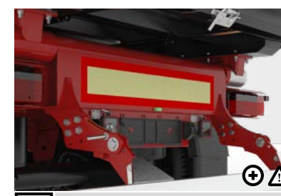
10 Hátsó vízmérték A hátsó zárlemezen elhelyezett vízmérték egy hatékony segédesszköz a vízszintes állás ellenőrzéséhez, ezáltal csökken a balesetveszély.
