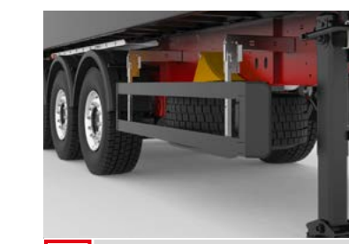
M Pótkerékartó A tartóban a pótkerék biztonságosan szállítható.
