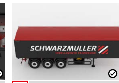
E Feltekerhető ponyva A feltekerhető ponyva védi az árut az időjárás- és károsodástól. A fel- és kitékerés a kezelőkarzatról lehetséges, a rögzítés gyorsesztyóval és gurnival történik.
