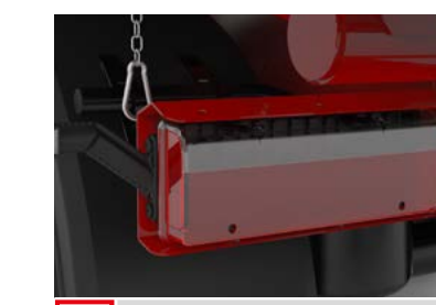
J LED-világítás A széria hátsó lámpa részben LED-es kialakítású. Opcionálisan teljesen LED-es kivétel is kérhető.
