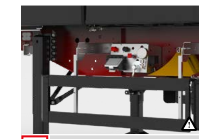
D Kezelőpult A könnyebb kezelhetőség érdekében a vezérlőegységek, mint például a fékoldószelep, emelő- süllyesztőselepek, süllyesztőgátló vagy a különböző felügyeleti rendszerek egy egységét képeznek.
