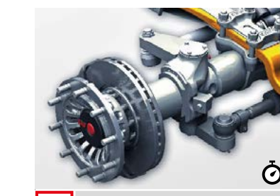
P Kormányzott tengely Talajkormányzott kivételben kérhető. Jobb manőverezhetőséget biztosít a pótkocsinak, valamint csökkenti a gumikopást.
