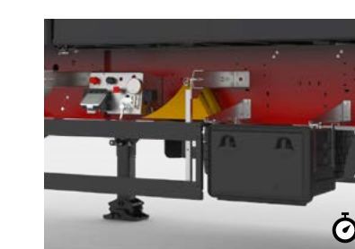
G Szerszámcsomagtartó Opcionálisan különböző méretű szerszámcsomagtartók is felszerelhetők a kocsira.
