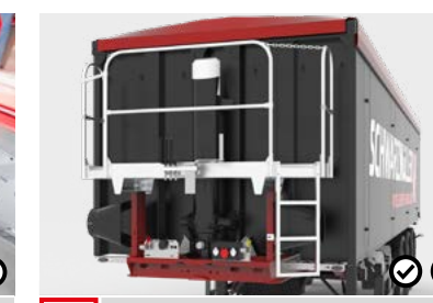
C Kezelőkarzat A kezelőkarzatnál lehet felmenni a puttony felső részéhez, itt felügyelhető a töltési folyamat valamint innen kezelhető a ponyva.
