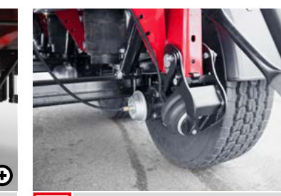
N Tengelyemelő A tengelyemelő azáltal, hogy tehertelen jármű esetén induláskor automatikusan felemeli a tengelyt, csökkenti a gumikopást. Ezen kívül indulássegélyként is használható.
