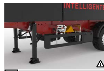
11 Oldalsó aláfutásgátló Az oldalsó aláfutásgátló biztonságot jelent a közlekedés más résztvevői számára.
