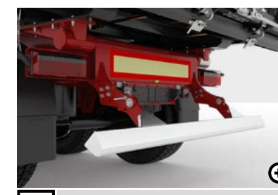
6 felhajtható hátsó aláfutásgátló A hátsó aláfutásgátló alapkitételben felhajtható kialakítású, amivel pl. egy garabba váio töltéskor biztosítható a szükséges szabad magasság a talajtól.
