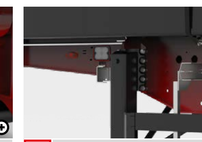
K Munkatérilámpa A munkatérilámpa segíti a biztonságos munkavégzést sötétben vagy rossz láthatási viszonyok között.
