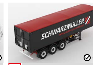
F Schwarzmüller-tető A ponyva nyitása és zárása egy elektromos tolóító-szerkezettel történik, távirányítással a kocsi mellől.
