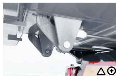
6 A hátsó ajtó reteszelésének automatikus kioldása
