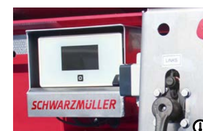
P Hőszigetelt puttony hőmérséklet rögzítése, 5 mérési ponttal
