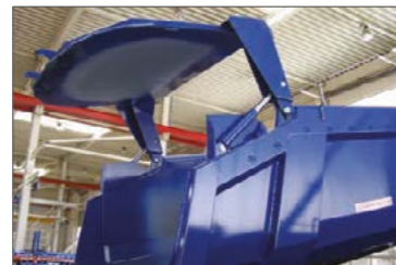
Különleges kivitelű hátsóajtó, extra nagy nyitással, automatikus hidraulikus működtetéssel
