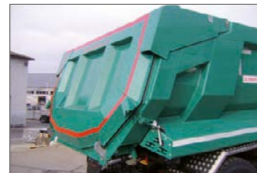
Kívülré záródó hátsó ajtó, tömítéssel
