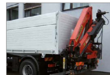
Gabonás kivitelű felépítmény fardaruval
