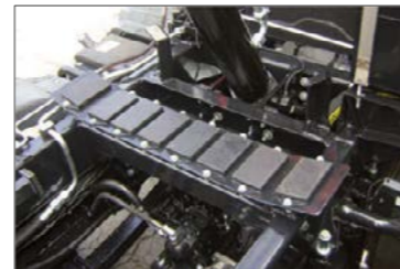
Gumialátétek a puttony stabil fekvése érdekében
