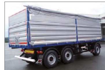
Építőipari billenő pótkocsi feltekerhető ponyvával és ajtómagasítással
