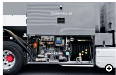
I Szivattyús mérőrendszer
