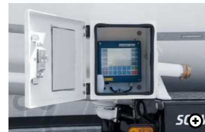
T Üvegszál erősítésű műanyag doboz a vezérlőhöz
