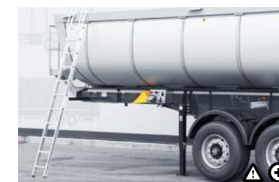
S Aufstiegsleiter Dank ihrer speziellen Form ermöglicht diese Aufstiegsleiter den gefahrlosen Ein- und Ausstieg in die Mulde für Wartungs- und Reinigungsarbeiten.
