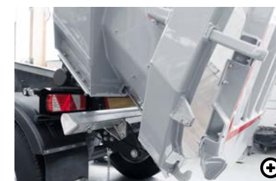
K Dosiereinrichtung Mit dem Anschlagbügel kann die Öffnungsweite der Heckklappe begrenzt werden. So lässt sich Schüttmaterial dosiert in den jeweils gewünschten Mengen abgeben.
