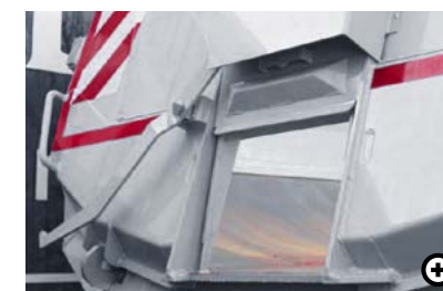
J Asphaltshuber (plus Vorstecker für Sperre) Eine kleine, zusätzliche Öffnung in der Heckklappe sorgt dafür, dass Asphalt-Ladegut ganz gezielt und in exakt dosierten Mengen abgegeben werden kann.
