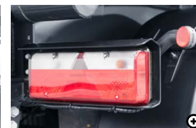
U LED-Beleuchtung Die Heckleuchte wird in der Standardversion als Teil-LED ausgeführt. Als optionale Ausstattungsvariante ist auch eine Ausführung als Voll-LED möglich.
