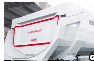
I Hydraulische Heckklappe Die Heckklappe lässt sich vollständig hydraulisch öffnen. So steht unmittelbar die komplette Öffnung zur Verfügung und es können auch große Steine problemlos entladen werden.
