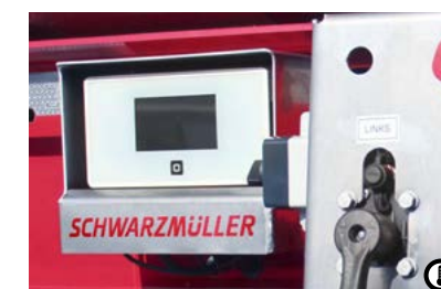
P Thermomulde Temperaturerfassung inkl. 5 Messpunkte Sensoren überwachen die Mischgut-Temperatur in der Mulde. So kann eine hohe Verarbeitungsqualität gewährleistet werden. Ein Erfassungsgerät speichert die Daten.
