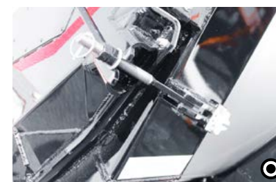
L Spanschrauben Zähflüssiges Transportgut erhöht den Druck auf die Heckklappe. Um dieser Belastung stand zu halten, werden zur Sicherung zusätzliche Spanschrauben montiert.
