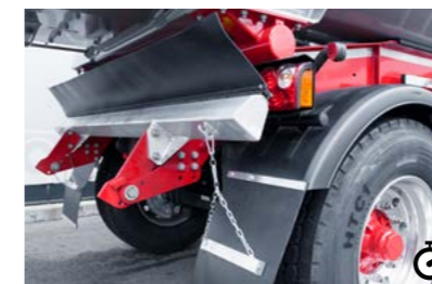
8 Klappbarer Unterfahrschutz Der Unterfahrschutz wird standardmäßig hochklappbar ausgeführt, damit bei einer Fertigerbeschickung stets die nötige Bodenfreiheit gewährleistet ist.
