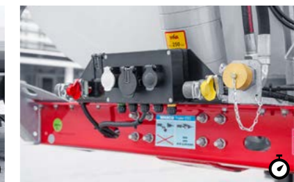
10 Brems- und Lichtanschlüsse Die Brems- und Lichtanschlüsse sind gemeinsam mit den Elektro- und Hydraulikan-schlüssen kompakt und übersichtlich an der Stirnseite des Fahrzeuges angeordnet.
