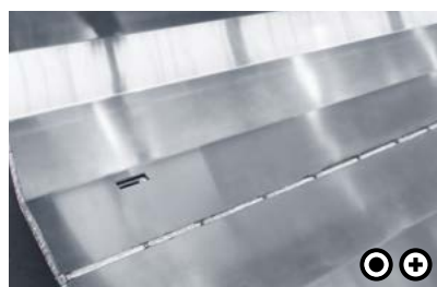
F Verschleißboden (Alu oder Stahl) Ein Alublech im Heckbereich schützt die Mulde vor frühzeitigem Verschleiß. Für schweres und abrasives Schüttmaterial empfiehlt sich zusätzlich ein 3 mm Hardox-Verschleißboden.
