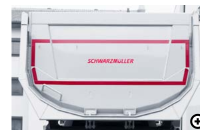
G Rückwand mit Schüttgasse Die Rückwand ist in die Mulde versetzt. So entsteht eine Schütte – der Schwerpunkt der Ladung liegt weiter vorne und erhöht den Druck auf die Zugmaschinen-Hinterachse.
