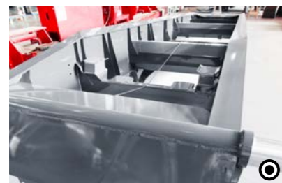
2 Torsionsrohre Diese speziellen Querverbindungen sorgen ähnlich wie der Torsionskasten für zusätzliche Stabilität des Kippersattels während des gesamten Kippvorgangs.
