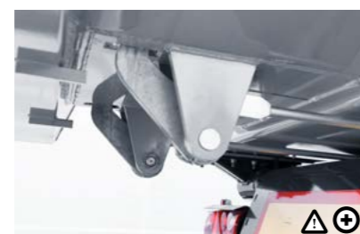
6 Automatische Entriegelung der Heckklappe Über ein spezielles Gestänge wird die Heckklappe beim Kippvorgang automatisch entriegelt. Auch die Verriegelung beim Absenken erfolgt dadurch automatisch.
