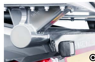
4 Einteilige Kipperwelle Die Kipperwelle wird nicht nur seitlich, sondern durchgehend angeschweißt. Durch diese Bauart erreicht man mehr Stabilität während des Kippvorgangs.
