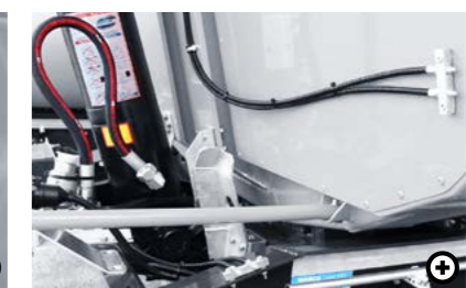
13 Zentralschmierleiste Von einer zentralen Schmierleiste aus können die 4 Schmierstellen der Kipperpresse versorgt werden. Das macht den Schmier-vorgang einfacher und spart zudem Zeit.
