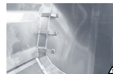
11 Aufstieg Mulde innen An der inneren Stirnwand der Segmentmulde sind mehrere, stabile Auftritte verschweißt. Dies ermöglicht ein problemloses und sicheres Ein- und Aussteigen.
