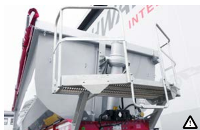
C Stehpodest Das Stehpodest dient dem Aufstieg zur Mulde, der Überwachung des Ladevorgangs sowie dem Öffnen und Schließen der Abdeckplane. Erhältlich in Alu oder Stahl.
