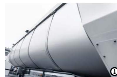
7 Thermomulde Die Mulde ist zur Gänze thermisch isoliert. Asphalt-Mischgut kann so mit höheren Temperaturen an die Baustelle gebracht werden, was die Einbauqualität erheblich steigert.
