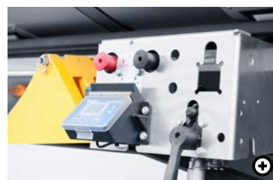
D Bedienpult Kollektive Anordnung von Steuerungselementen wie Bremslöseventile, Hub- und Senkeinrichtung, Trailerüberwachungen oder Absenksperre für eine einfachere Bedienung.
