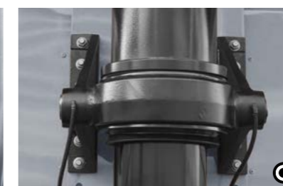
12 Vier-Punkt-Lagerung Die Kipperpresse ist an vier Positionen (je zwei Mal oben und unten) gelagert. Das schafft eine einzigartige Kippstabilität gegenüber einer Drei-Punkt-Lagerung.
