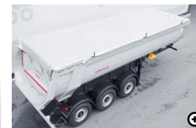
N Rollplane Eine aufrollbare Plane schützt Ladegut vor Wetter und Verlust. Das Auf- und Zurollen erfolgt vom Stehpodest aus, die Sicherung mit Schnellspannern und Gurten.
