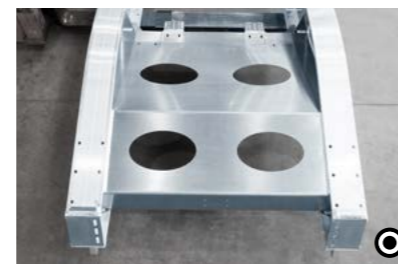
1 Torsionskasten Eine bewährte und durchdachte Lösung, um im Heckbereich des Kippersattelfahrzeuges optimale Stabilität während des gesamten Kippvorgangs zu gewährleisten.
