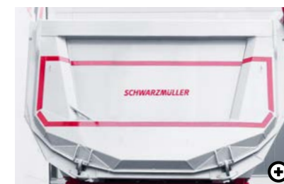
H Rückwand ohne Schüttgasse Die Rückwand bzw. die Klappe werden bei dieser Bauart heckseitig angeschlagen. Dadurch erhöht sich das Fassungsvermögen der Mulde um rund 1,5 Kubikmeter.
