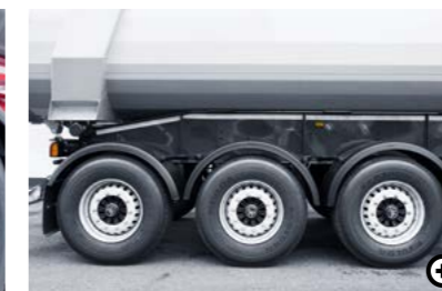
9 Einzelradkotflügel Schwarzmüller Kippersattel verfügen über Einzelradkotflügel. Das schützt andere Verkehrsteilnehmer, aber auch die Mulde vor Steinschlägen und Verschmutzung.
