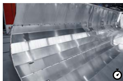
E Alumulde Die Kippmulde wird zur Gänze aus Aluminium gefertigt. Der dadurch gewonnene Gewichtsvorteil gegenüber der Stahlmulde beträgt rund 900 Kilogramm.
