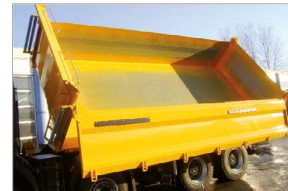
3-Seiten-Kippaufbau auf 4-Achs-LKW, mit Stahl-Seitenwände
