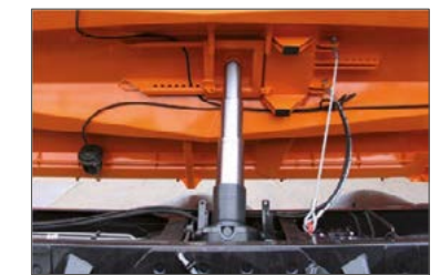
Kardanische Mittelpresse für 3-Seiten-Kippung
