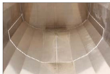
Aluminium-Verschleißboden im hinteren Bereich
