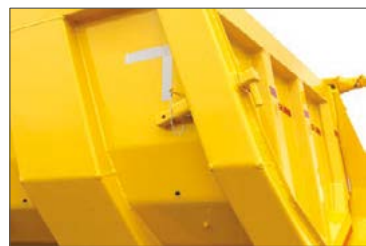
Dosiereinrichtung für Pendel-Rückwand mit ausziehbarem Rohranschlag
