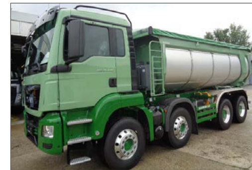
Thermomulden-Kippaufbau auf 4-Achs-LKW
