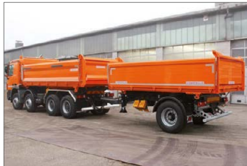
Gesamtzug – 3-Seiten-Kippaufbau auf 4-Achs-LKW mit 1-Achs-3-Seiten-Kipphanhänger
