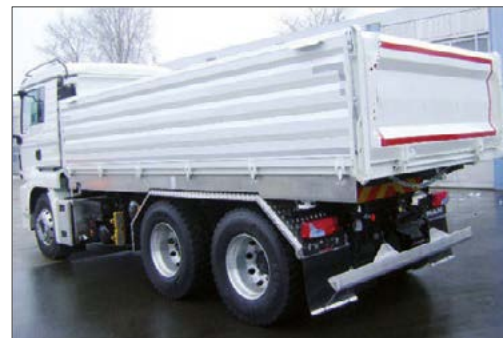
Gesamtzug – 3-Seiten-Kippaufbau auf 3-Achs-LKW mit Zentralachs-3-Seiten Kipphanhänger
