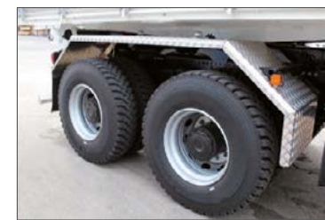
Hinterradabdeckung mit durchgehende Alu-Riffelblech-Kotflügel
