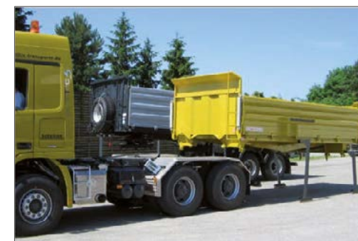
3-Seiten-Kippaufbau auf 3-Achs-LKW, vorgerichtet für Sattelbetrieb
