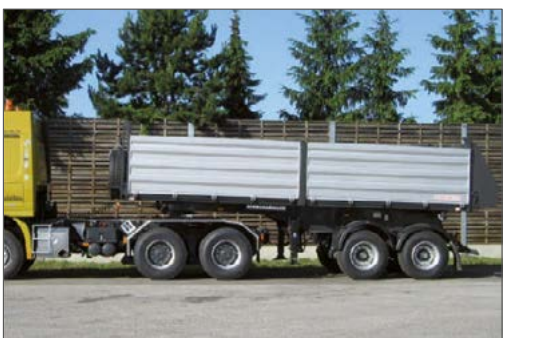
3-Seiten-Kippaufbau auf 3-Achs-LKW, vorgerichtet für Sattelbetrieb
