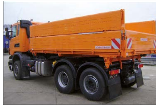
3-Seiten-Kippaufbau auf 2-Achs-LKW – Baustelle, für den kommunalen Bereich
