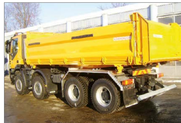
3-Seiten-Kippaufbau auf 4-Achs-LKW, mit Stahl-Seitenwände
