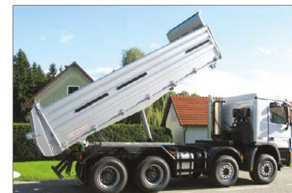
3-Seiten-Kippaufbau auf 4-Achs-LKW, mit Stahl-Seitenwände
