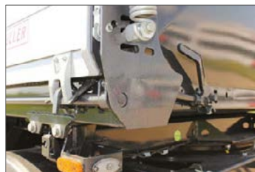
Mechanische Zentralverriegelung der Seitenwände
