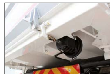
Pneum. Rückwand-Verriegelung vom Fahrerhaus zu öffnen
