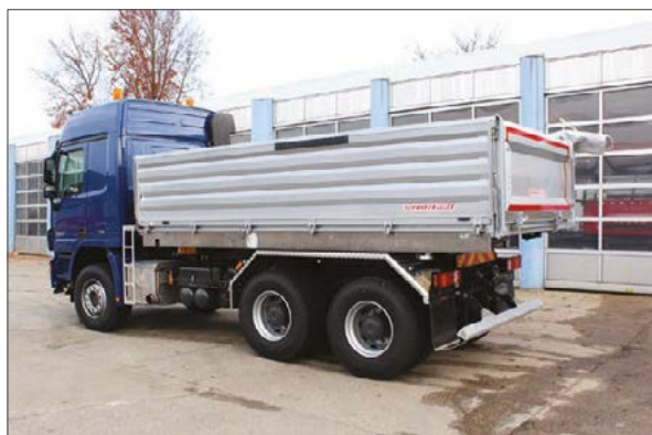
3-Seiten-Kippaufbau auf 3-Achs-LKW – Baustelle
