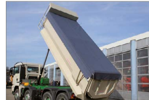
Kunststoff-Rollplane inkl. Aluminium-Rohr samt Handkurbel; linksseitig mit 2 Spanngurte sowie Spannschlösser auf Muldenunterseite; rechtsseitig waagrechte Planenbügel-Seilverschnürung
