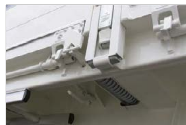
Unterflur-Hebehilfe zum leichteren abklappen der Bordwände
