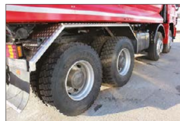
Hinterradabdeckung mit durchgehende Alu-Riffelblech-Kotflügel
