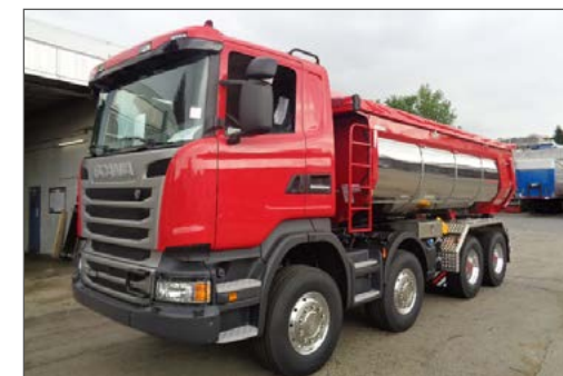
Thermomulden-Kippaufbau auf 4-Achs-LKW
