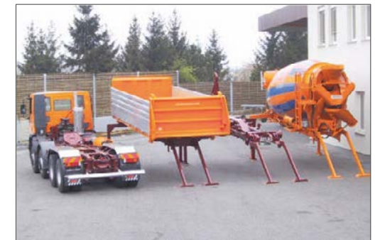
3-Seiten-Kippaufbau auf 4-Achs-LKW, mit Betonmischer- und Abrollkipper-Wechselsystem, sowie vorgerichtet für Sattelbetrieb
