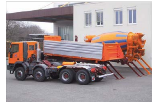
3-Seiten-Kippaufbau auf 4-Achs-LKW, mit Betonmischer- und Abrollkipper-Wechselsystem, sowie vorgerichtet für Sattelbetrieb
