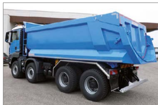
Stahl-Segmentmulden-Kippaufbau auf 4-Achs-LKW, in Gesteinsausführung
