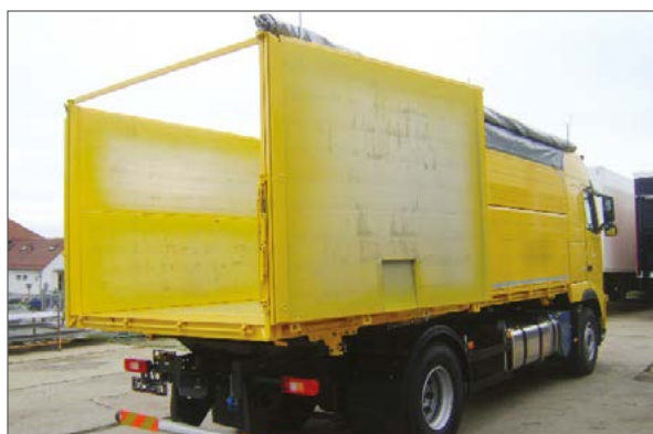
3-Seiten-Kippaufbau auf 2-Achs-LKW – Fernverkehr
