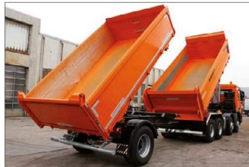
Gesamtzug – 3-Seiten-Kippaufbau auf 4-Achs-LKW mit 1-Achs-3-Seiten-Kipphanhänger
