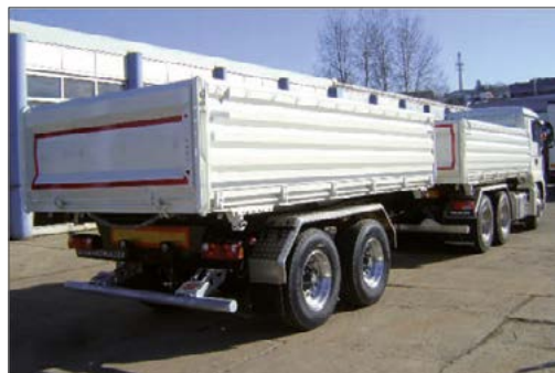
Gesamtzug – 3-Seiten-Kippaufbau auf 3-Achs-LKW mit Zentralachs-3-Seiten Kipphanhänger
