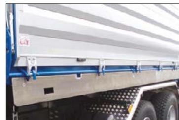
Aluminium-Schüttleiste auf Zentralverriegelungswelle
