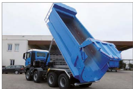
Stahl-Segmentmulden-Kippaufbau auf 4-Achs-LKW, in Gesteinsausführung
