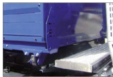
Stehpodest vorne zwischen Kipperbrücke und Fahrerhaus
