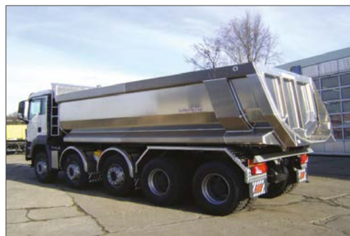
Aluminium-Segmentmulden-Kippaufbau auf 5-Achs-LKW
