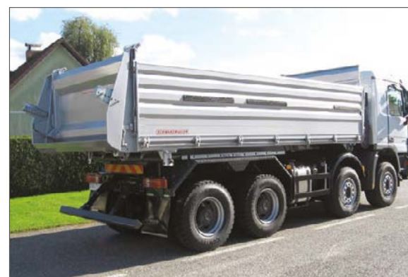
3-Seiten-Kippaufbau auf 4-Achs-LKW – Baustelle
