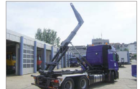
3-Seiten-Kippaufbau mit Abrollkipper-Wechselsystem auf 3-Achs-LKW
