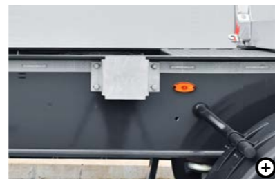
2 Greiferabweisbleche Die Greiferabweisbleche an den Längsträgern beugen beim Entladen Schäden durch Greifer vor.
