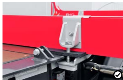
1 Aufgesetzte Rungenschemel Sie sind mit einer Klemmbefestigung am Fahrzeug verbunden und dadurch beliebig horizontal verschiebbar. Sie dienen dem sicheren Transport des Ladegutes (Rundholz).
