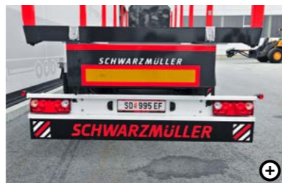
3 Alu-Unterfahrerschutz Dieser sorgt dafür, dass der Anhänger bzw. Sattel nicht unterfahren werden kann. Das erhöht die Sicherheit für andere Verkehrsteilnehmer. Optional auch in Stahl oder Edelstahl.
