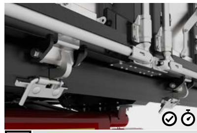
5 Automatischer Pendelverschluss Über ein spezielles Gestänge wird die Heckklappe beim Kippvorgang automatisch entriegelt. Auch die Verriegelung beim Absenken erfolgt dadurch automatisch.
