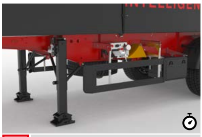
L Stützwinden Schwarzmüller bietet hier mehrere Möglichkeiten: Kurbelwinden oder Fallstützen jeweils aus Stahl oder Alu.
