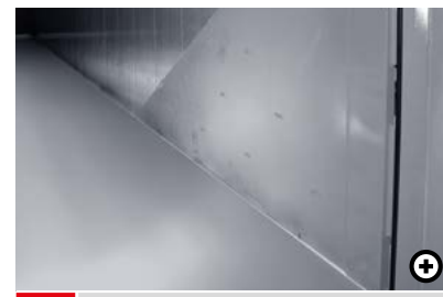
H Aluminiumverschleißbleche Beidseitige Verstärkungen im Heckbereich der Mulde schützen vor schnellem Verschleiß und erhöhen somit die Lebensdauer.
