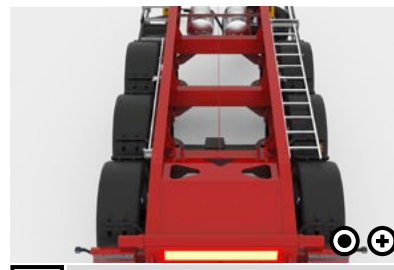
3 Paralleler Rahmen Ein Vorteil im Vergleich zu Fahrzeugen vieler Mitbewerber ist die parallele Führung der beiden Längsräume. So entsteht mehr Stabilität in jeder Situation.
