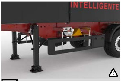
11 Seitenschutz Der seitliche Anfahrerschutz erhöht die Sicherheit für andere Verkehrsteilnehmer.
