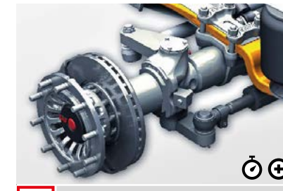
P Lenkachse Verfügbar als reibungsgeleitete Nachlaufachse. Diese dient der höheren Wendigkeit des Anhängers und reduziert den Reifenverschleiß.
