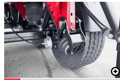
N Liftachse Reduzieren den Reifenverschleiß durch automatisches Anheben von Achsen bei Leerfahrten. Dienen auch als Anfahrhilfe.
