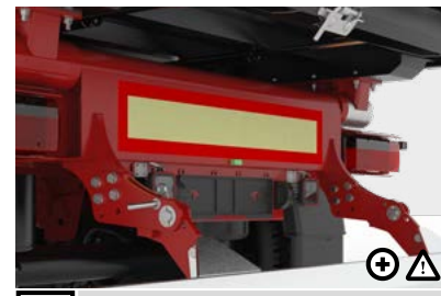
10 Libelle hinten Die Libelle am Abschlußblech ist ein einfaches Hilfsmittel zur Kontrolle der Waagrechtstellung und reduziert somit das Unfallrisiko.
