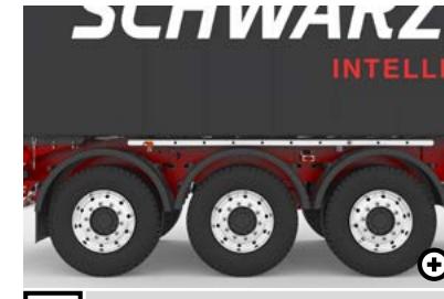
7 Einzelradkotflügel Schwarzmüller Kippsattel verfügen über Einzelradkotflügel. Das schützt andere Verkehrsteilnehmer, aber auch die Mulde vor Steinschlägen und Verschmutzung.
