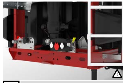
8 Brems- und Lichtanschlüsse Die Brems- und Lichtanschlüsse sind gemeinsam mit den Elektro- und Hydraulikan-schlüssen kompakt und übersichtlich an der Stirnseite des Fahrzeuges angeordnet.
