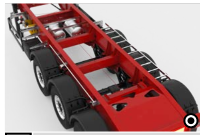
2 Torsionsrohre Diese speziellen Querverbindungen sorgen ähnlich wie der Torsionskasten für zusätzliche Stabilität des Kippsattels während des gesamten Kippvorgangs.
