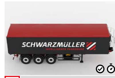
E Rollplane Eine aufrollbare Plane schützt Ladegut vor Wetter und Materialverlust. Das Auf- und Zurlösen erfolgt vom Stehpodest aus, die Sicherung mittels Schnellspanner oder Gurten.
