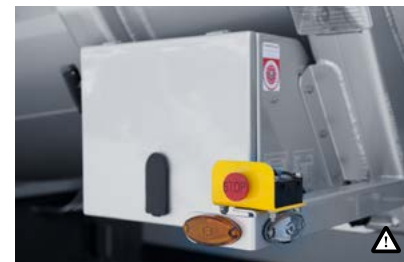
H Not-Ausschalter Links und rechts befindet sich ein leicht erreichbarer Not-Ausschalter, der die Be- bzw. Entladung unterbricht.
