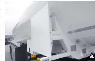
R Beschriftungstafeln Zwei seitlich entnehmbare Beschriftungstafeln in Steckrahmen. Beidseitig verwendbar. Abmessung ca. 80 x 80 cm.
