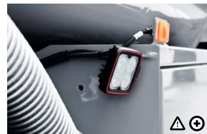
L Arbeitsscheinwerfer Die LED-Leuchten sorgen für eine zusätzliche Beleuchtung während des Be- und Entladevorganges.
