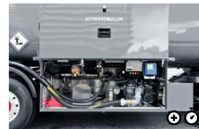
J Freifallmessanlage Anstelle eines elektronischen Peilstabes ist eine Freifallmessanlage zur Abgabe im freien Gefälle verfügbar.
