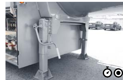
B Stützwinden Schwarz Müller bietet unterschiedliche Stützwinden zur Wahl: Entweder als Kurbelwinde aus Stahl oder Alu oder als Fallstützen aus Stahl oder Alu.
