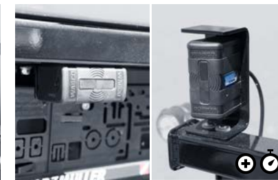
U Wabco Tail-Guard Sicherheitssystem mit drei Sensoren, das die Rückraumüberwachung mit automatischem Bremsen kombiniert.
