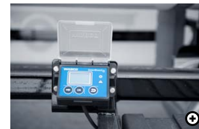
D SmartBoard Das SmartBoard von Wabco zeigt unterschiedliche Fahrzeugdaten über ein integriertes Display.
