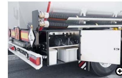
P Aluminium-Zubehörkasten Die seitlich öffnende Tür mit Kompressionsverschluss ermöglicht eine leichte Bedienbarkeit und zusätzlichen Platz für diverses Zubehör.
