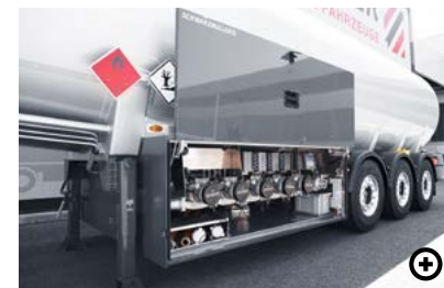
F Durchgehender Armaturenschrank Aus Alu mit beidseitiger Produktsammelrinne. Links: Gasrückführanschluss und API-Befüllkupplungen. Rechts: Einzelabläufe.
