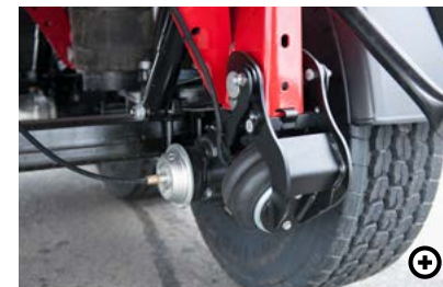
C Liftachse Die Liftachsen reduzieren den Reifenverschleiß durch automatisches Anheben von Achsen bei Leerfahrten. Sie dienen auch als Anfahrhilfe.
