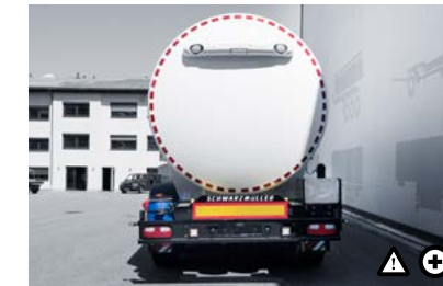
M Hochgesetzte Rückleuchten 2 hochgesetzte Rückleuchten samt Leuchtenträger für verstärkte Aufmerksamkeit.
