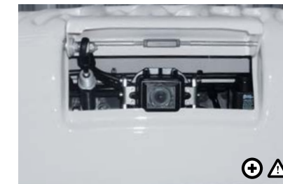
S Rückfahrkamera Sie bietet zusätzliche Sicherheit bei der Rückwärtsfahrt. Der Kameradeckel öffnet pneumatisch.
