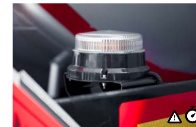
V Blitzleuchte Die LED-Blitzleuchte warnt andere Verkehrsteilnehmer.
