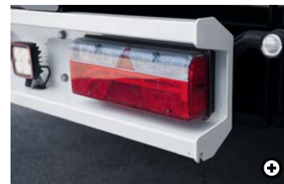
K LED-Beleuchtung Die Heckleuchte wird in der Standardversion als Teil-LED ausgeführt. Als optionale Ausstattungsvariante ist auch eine Ausführung als Voll-LED möglich.
