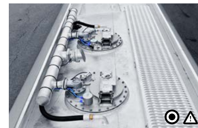
E Top-Loading (Überlaufwanne) Die durchgehende Überlaufwanne ist mit Laufsteg, klappbarem Geländer, Domdeckel samt Schnellfülldeckel und einer Aufstiegsleiter ausgestattet.
