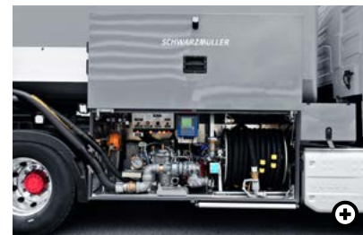
I Pump- und Messanlage Für Leer- und Vollschauchsysteme verfügbar. Als Alternative zum elektronischen Peilstab.
