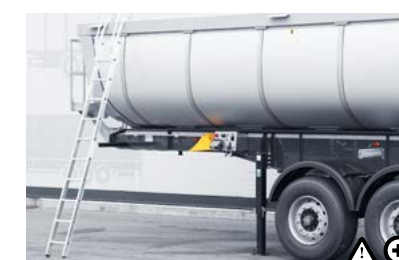
S Výstupní žebřík Díky svému speciálnímu tvaru umožňuje tento výstupní žebřík bezpečný vstup a výstup do korby a z korby pro provádění údržby a čištění.
