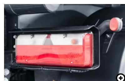
U Osvětlení LED Zadní svítidla jsou ve standardní verzi v provedení částečné LED. Jako volitelné je možné i provedení plně LED.
