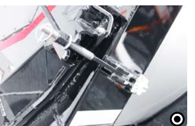
L Napínáky Částečně tekoucí náklad zvyšuje tlak na zadní čelo. K zastavení tohoto zatížení se montují dodatečné napínáky.
