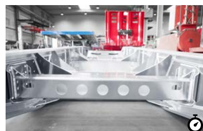
A Hliníkový rám Volitelný hliníkový rám přináší úsporu hmotnosti 250 kg proti ocelové konstrukci.
