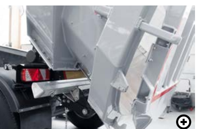
K Dávkovací zařízení S dorazovými třmeny lze omezit otevření zadního čela. Tak lze dávkovat spyký materiál v libovolném množství.
