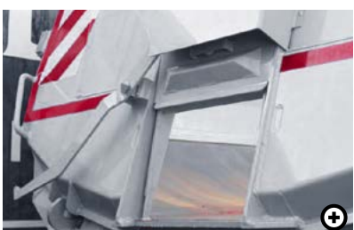
J Výsypné okénko - asfalt Malé dodatečné okénko v zadním čele slouží k cílenému a dávkovanému výdeji materiálu - asfaltu.
