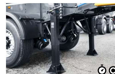
W Opěrné nohy Schwarzmüller nabízí různé provedení opěr. Buď vráték s klikou v oceli nebo hliníku, nebo nouzové opěry v oceli nebo hliníku.
