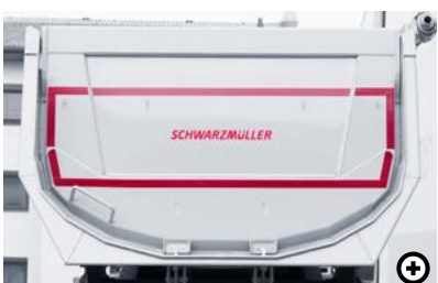
G Zadní čelo s výsypným prodloužením Zadní čelo je vsazeno do korby. Tak vzniká výsypné prodloužení. Těžší náklad leží více vpředu a zvyšuje tlak na zadní nápravu taháče.
