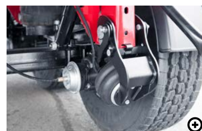
X Zvedací náprava Snižování opotřebení pneumatik, díky automatickému zvednutí při prázdných jízdách. Slouží také jako pomoc při rozjezdu.
