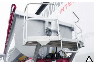
C Obslužná podesta Obslužná podesta slouží k výstupu na korbu, kontrole nákladu, jakož i otevření a zavření plachty. Provedení v oceli nebo hliníku.
