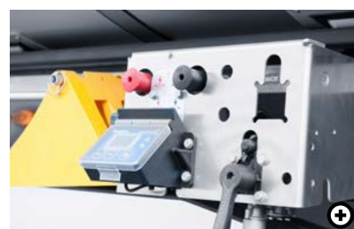
D Ovládací pult Společné uspořádání a jednoduchá obsluha ovládacích částí, jako brzdových ventilů, zvedání a spouštění, kontrolních funkcí, jakož i vyřízení vypouštění měchů při sklápění.
