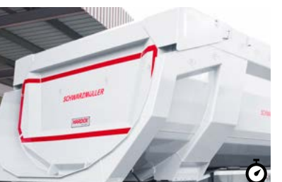
I Hadraulické zadní čelo Zadní čelo se dá hydraulicky plně otevřít. Tak je k dispozici okamžitě celé otevření korby a lze tak bez problémů vykládat i velké kameny.
