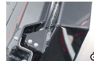
M Gumové těsnění Dodatečné gumové těsnění zadního čela slouží spolehlivě v nejvyšší míře k zajištění nutné těsnosti korby.
