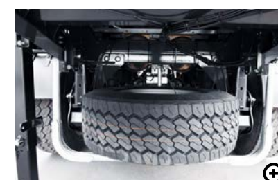
T Držák rezervního kola Pro bezproblémové převážení rezervního kola.
