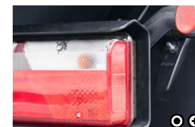
V Ochrana světla Aby bylo chráněno co nejlépe před poškozováním a zašpiněním, je zadní osvětlení umístěno do plechového zakrytí.
