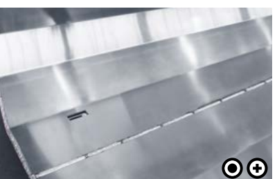
F Vyměnitelná opotřebitelná výstýlka podlahy (ocelová nebo hliníková) Hliníkový plech v zadní části chrání korbu proti předčasnému opotřebení. Pro těžší a abrazivnější spyký materiál je doporučená dodatečná výstýlka z 3mm hardoxového plechu.
