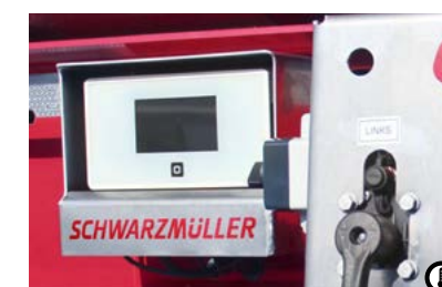
P Registrace teploty u thermo korby, vč.5 měřících bodů Senzory hlídají teplotu balené v korbě. Tak lze zajistit vysokou kvalitu zpracování. Registrační přístroj ukládá data.
