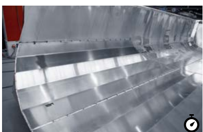
E Hliníková korba Sklápěcí korba je celá z hliníku. Tímto získaná úspora hmotnosti oproti ocelové korbě činí okolo 900 kg.
