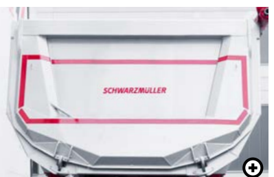
H Zadní čelo bez výsypného prodloužení Zadní čelo je při tomto provedení až vzadu. Díky tomu se zvýší objem korby o ca 1,5 cbm.
