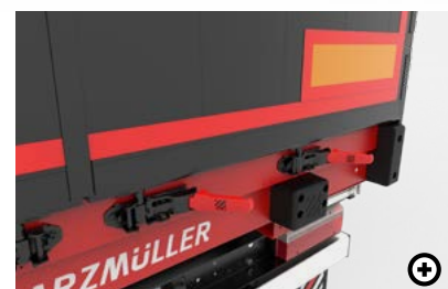
6 Uzávěr dveří jednou rukou Uzavírací páky zadních dveří lze otevřít a zavřít jednou rukou.
