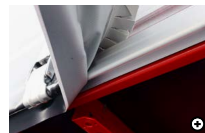
1 Lišta pro uchycení plachty Umožňuje vertikální připevnění boční plachty k vnějšímu rámu. Zajišťuje čistý povrch, a to i bez upnutí svorek pod úhlem.
