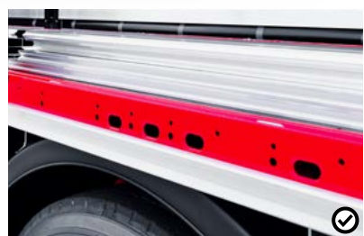
8 Děrovaný vnější rám Kromě upínacích popruhů lze k otvorům děrovaného vnějšího rámu v jakékoli požadované poloze připevnit zajišťovací háky pro náklad.
