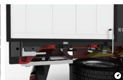
17 Zajišťovací zařízení pro zadní dveře Otevřené zadní dveře jsou zajištěny tak, aby neočekávaně nezabouchly.
