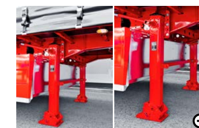
21 Opěrné nohy s vyrovnáním posunu Vyrovnání posunu zabraňuje ohnutí podpěrných nohou při dosedání vřadu u zaparkovaného návěsu.
