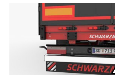
18 Ochranné dorazy Tyto gumové dorazy chrání před poškozením při nájezdu k rampě.
