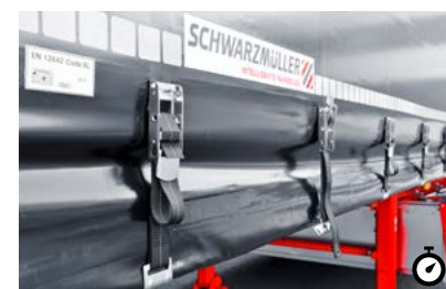
2 Plachtové napínačky přes střed Speciální napínačky slouží k připevnění plachty k vnějšímu rámu a podpoře zajištění nákladu.
