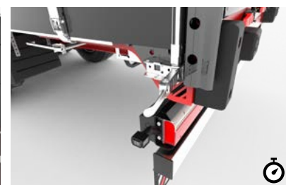
20 Napínací ráčna Umožňuje rychlé napnutí boční plachty. Jsou připevněny vzadu vlevo a vpravo ve směru jízdy.
