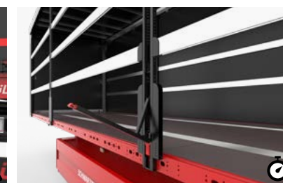
19 Posuvné sloupky Jednoduchý a rychlý posuv středových sloupků do strany otevře celou nakládací šířku.
