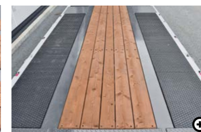
10 Modřinová podlaha Ložná plocha je z modřinových prken. Volitelně je možné též z tvrdého dřeva.
