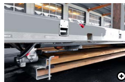
6 Odkládací držák pro prkna pro rozšíření Dřevěná prkna pro rozšíření se nacházejí v odkládacím držáku pod nakládací plochou.
