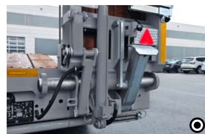
4 Sklopné opěry na rampách Při sklopení ramp vyjedou automaticky sklopné opěry. Zabraňují při nakládce vyskočení předku přívěsu nahoru.
