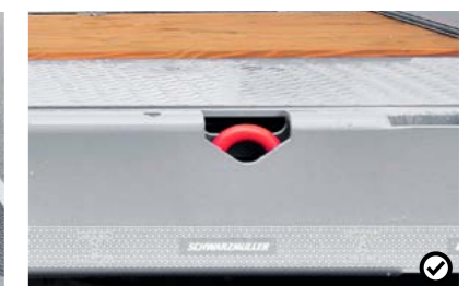
11 10t kotevní oka Sklopná kotevní oka slouží k zajištění přepravovaného nákladu.
