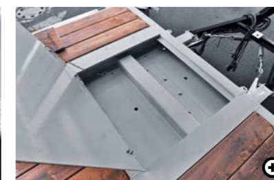
13 Odkládací prostor pro výbavu Odkládací prostor vpředu v plošině slouží k přepravě výbavy a nářadí.
