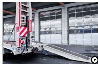
2 Sklopné jednodílné nájezdové rampy Pro najetí na ložnou plochu se nájezdové rampy sklopí.
