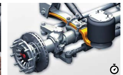
14 Natačecí náprava Pro lepší říditelnost přípojných vozidel, snižuje opotřebení pneumatik. Jako třecí vlečná náprava nebo hydraulicky ovládaná natačecí náprava.
