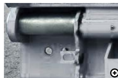
3 Rampy posuvné do strany Obě rampy se nechají ručně posunout do strany. Lze tak bez problémů naložit i vozidla s různým rozchodem.
