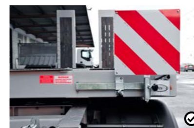
7 Roztažné výstražné cedule Slouží k variabilnímu označení šířky vozidla, aby bylo možno provádět bezpečnou přepravu vozidel překračujících povolenou šířku.
