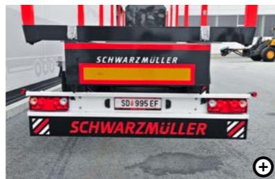
3 Hliníková zadní ochrana proti podjetí (zadní nárazník)
