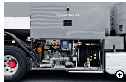
I Měřicí zařízení s čerpadlem K dispozici pro systém prázdné a plně hadice. Jako alternativa k elektronickým měřným tyčím.
