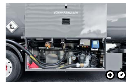
J Samospádové měřicí zařízení. Namísto elektronických měřných tyčí je k dispozici samospádové měřicí zařízení pro výdej samotíží.
