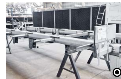
A Nerezový rám Šroubovaný nerezový rám umožňuje umístění 2 ks 3" hadic v délce do ca. 4,6 m
