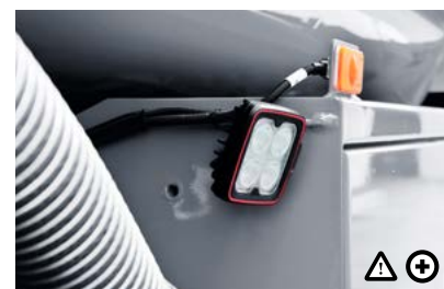
L Pracovní světlo LED světlo je starší o dodatečné osvětlení v průběhu výjeje a plnění.
