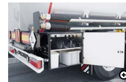
P Hliníkový kastlík na příslušenství Otevíráný do boku s tlakovým uzávěrem umožňuje lehkou obsluhu a poskytuje dodatečný prostor pro různé příslušenství
