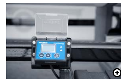
D SmartBoard SmartBoard od Wabco ukazuje různá data o vozidle na integrovaném displeji.
