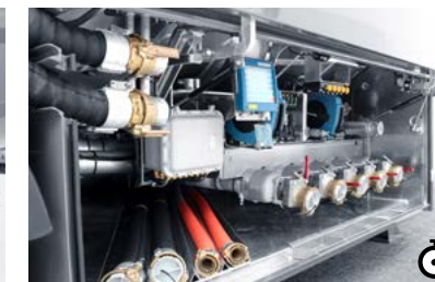
8 Samostatné výpustné potrubí
