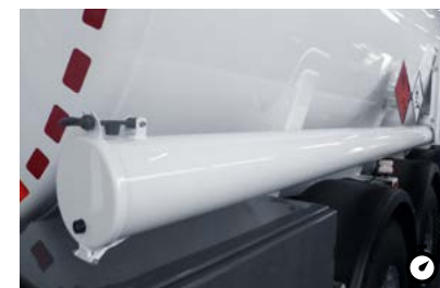
G Tubus na hadice Vozidlo může být vybaveno jedním 7,5 m dlouhým tubusem na hadice.
