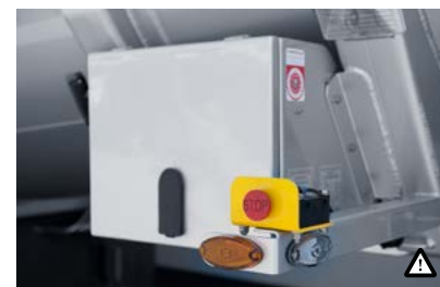
H Nouzový vypínač Vlevo a vpravo se nachází lehce dosažitelný nouzový vypínač, který přeruší nakládku nebo vykládku.
