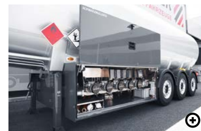
F Průběžná armaturní skříň Z hliníku s oboustranným sběrným zlábkem produktu. Vlevo napojení odvodu zpětných par a plnicích spojek API. Vpravo samostatně vypustné potrubí pro každou komoru.
