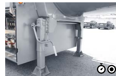
B Opěrné nohy Schwarzmüller nabízí na výběr různé opěrné nohy: buď jako vrátek s klikou z oceli nebo hliníku, nebo nouzové opěry z oceli nebo hliníku.
