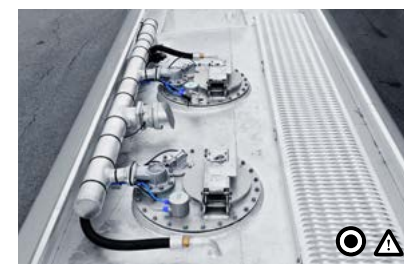
E Vrchní plnění (přetoková vana) Průběžná přetoková vana je vybavena lávkou, sklápěným zábradlím, dómem vč. rychloplnicího víka a výstupního žebříku.
