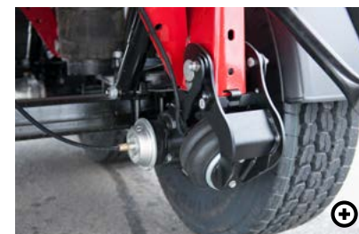
C Zvedací náprava Zvedací nápravy snižují opotřebení pneumatik díky automatickému zvednutí náprav při prázdné jízdě. Slouží však také jako pomoc při rozjezdu.
