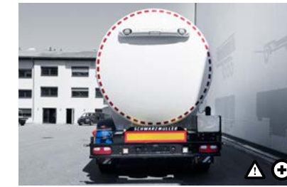
M Zadní osvětlení nahoře na kupoli nádrže 2 couvací světla nahoře na kupoli nádrže včetně držáku světel pro zesílení pozornosti.
