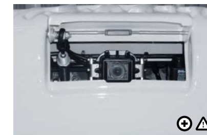
S Couvací kamera Nabízí dodatečnou jistotu při couvání. Víko kamery se otevírá pneumaticky.
