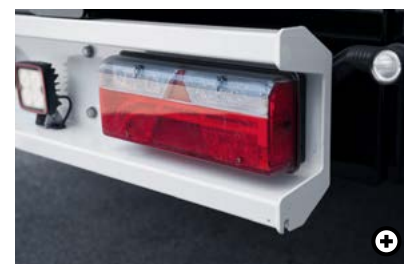
K LED osvětlení Zadní svítlny jsou ve standardní verzi dodávány jako částečné LED. Jako volitelná varianta výbavy je možné i provedené plně LED.
