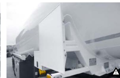
R Panely a cedule Na bocích 2 odnímatelné panely s cedulemi v zasouvacím rámečku, oboustranně použitelné, rozměr ca. 80x80 mm
