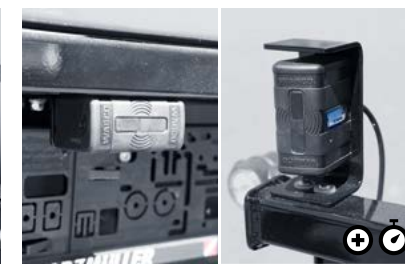
U Wabco Tail Guard Bezpečnostní systém se třemi couvacími senzory, kombinujícími sledování prostoru za vozidlem s automatickým přibrzdováním.
