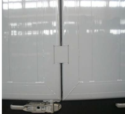
Drzwi w ścianie bocznej: sprawdzić zawiasy pod kątem poprawności działania i uszkodzeń, sprawdzić mocowanie zawiasów pod kątem uszkodzeń i trzymania
