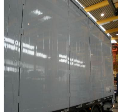
Drzwi w ścianie bocznej: sprawdzić zawiasy pod kątem poprawności działania i uszkodzeń, sprawdzić mocowanie zawiasów pod kątem uszkodzeń i trzymania
